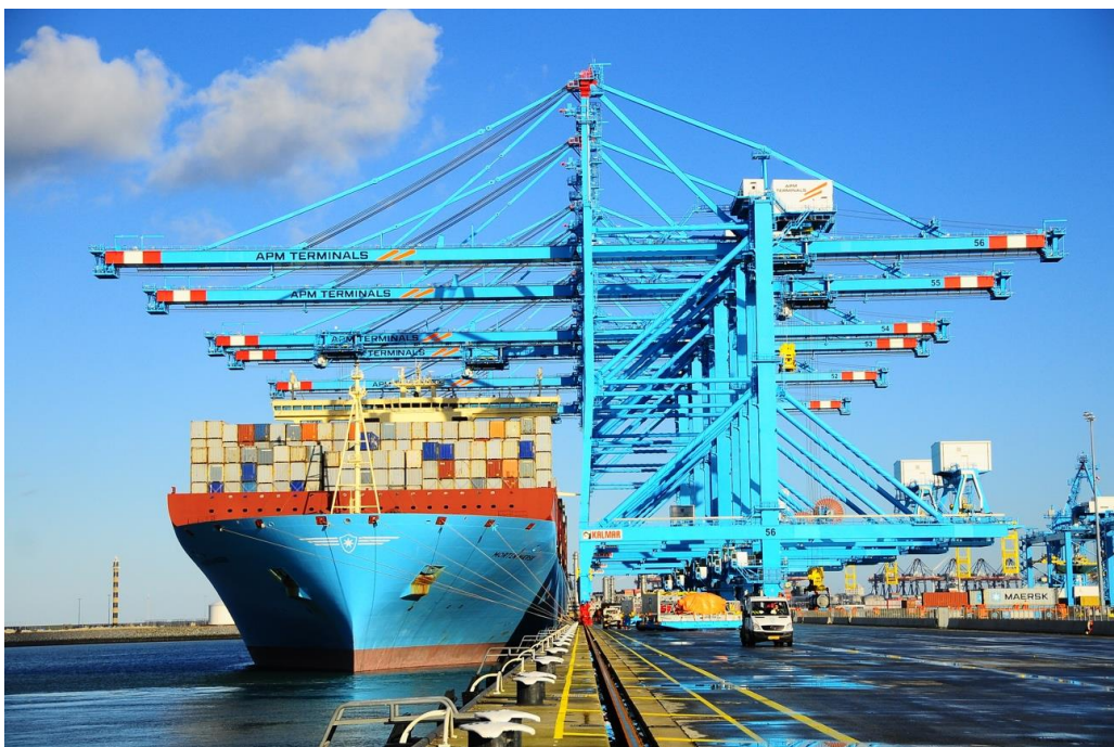
Figura 10. Grúas double trolley en APM Terminals Maasvlakte II. Fuente: APM Terminals Flickr.
