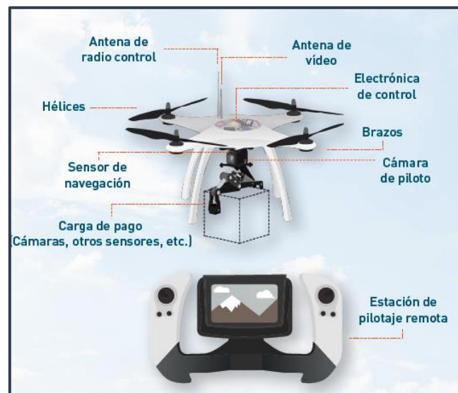
Figura 2. Elementos Básicos de Dron Multirrotor. (Fuente: Ministerio de Fomento)
