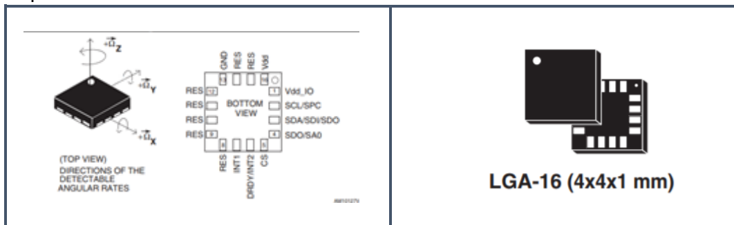
Figura 14. Giroscopio digital L2GD20
