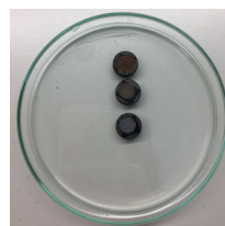
Porta muestras de carbono y microscopio electrónico de barrido
