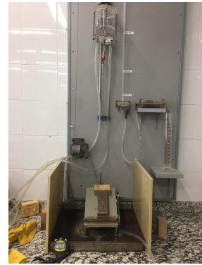
Depósito, soportes y tubo para ensayo SAET
