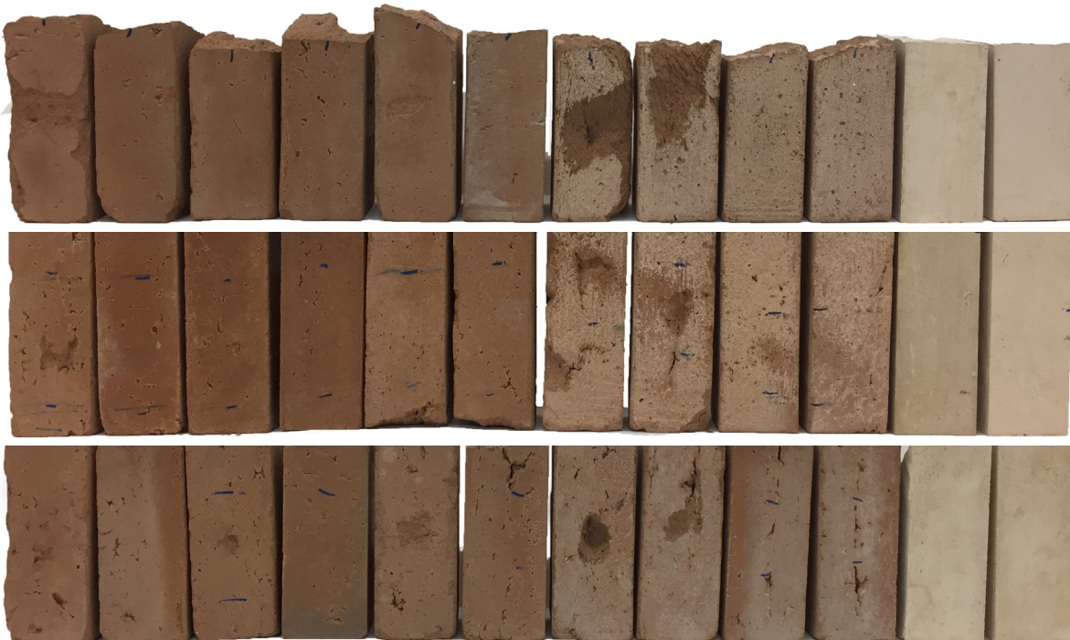
Comparación visual de la evolución de dureza superficial respecto al tiempo de curado 28 días , 63 días y Envejecimiento (+UV) respectivamente
