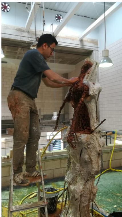
Fig. 184. Desmontaje del molde.
