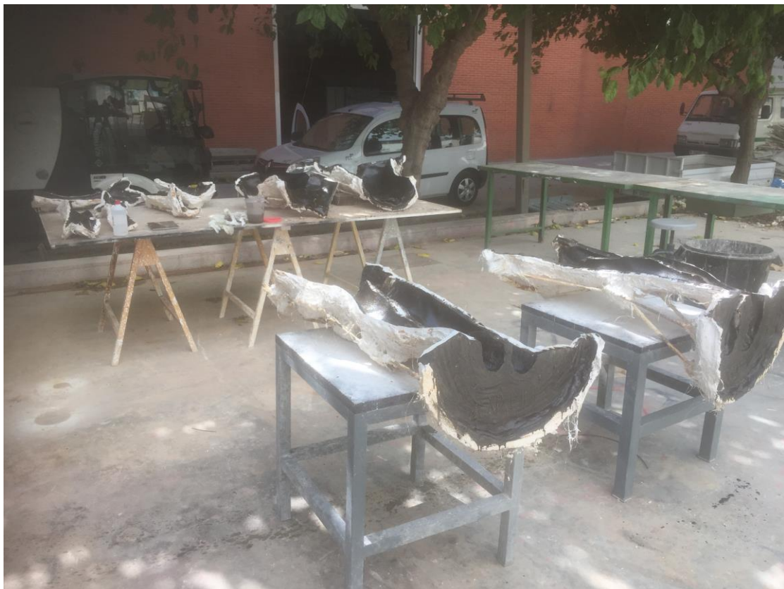
Fig. 188. Primeras capas de resina.
