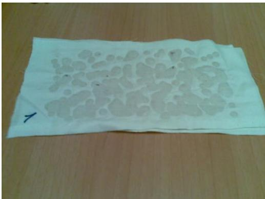
Figura 13 Muestra con laminado discontinuo
