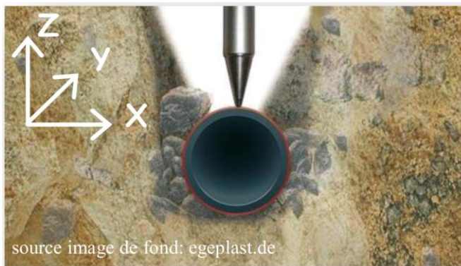
Figure 18 : Méthode de relevé des réseaux
