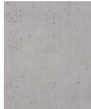
11.4. Tipos de acabados (con lámina adherida de 2 mm). Ref. Preborquisa
