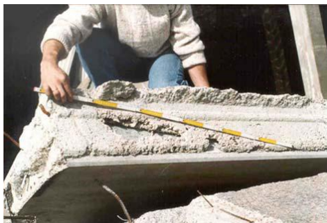
14.1. Accidentes en un forjado y en un panel por no respetar las tolerancias máximas
