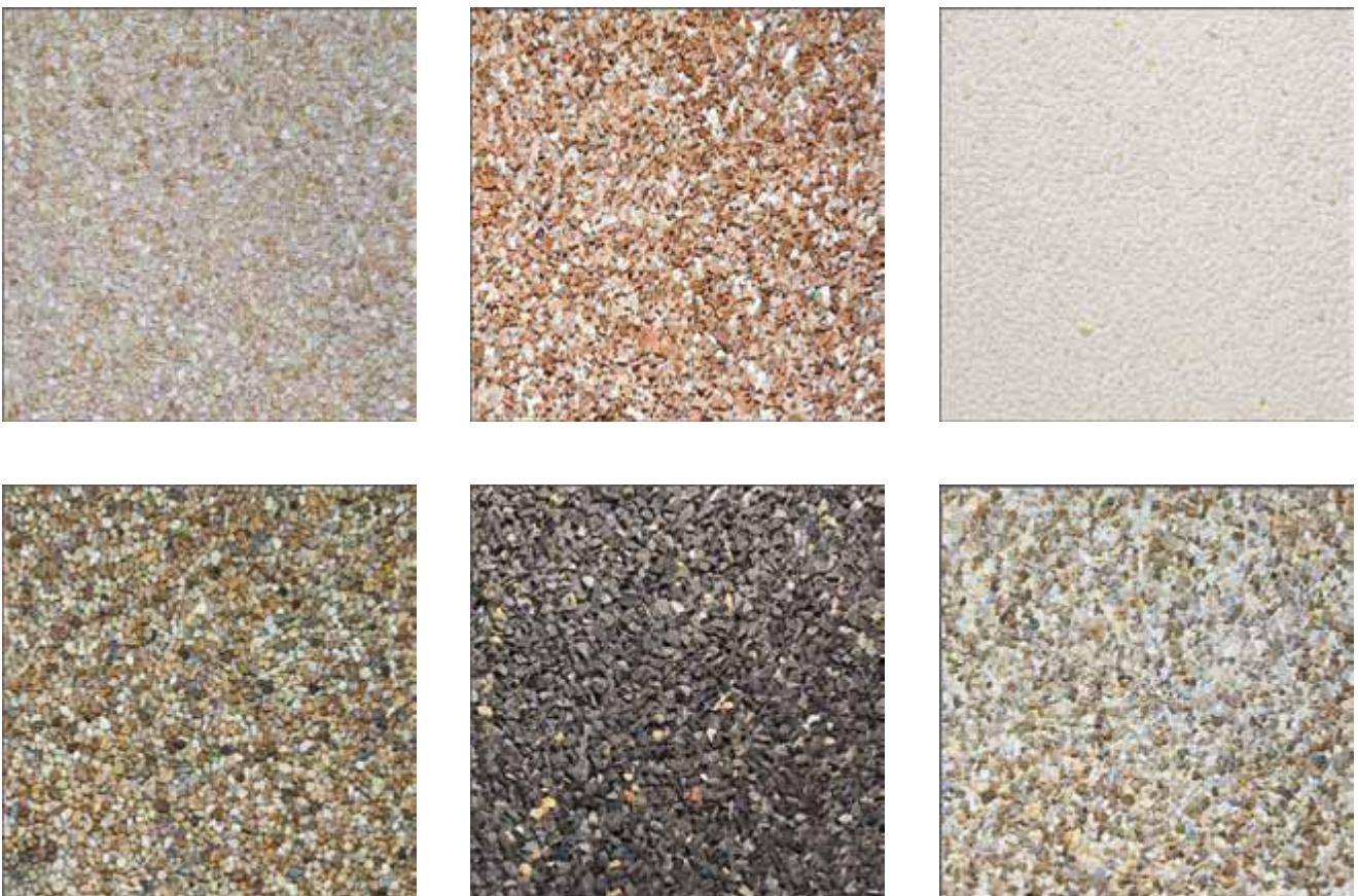
11.7. Tipos de acabados (árido lavado despues de endurecer el hormigón). Ref: tecnyconta
