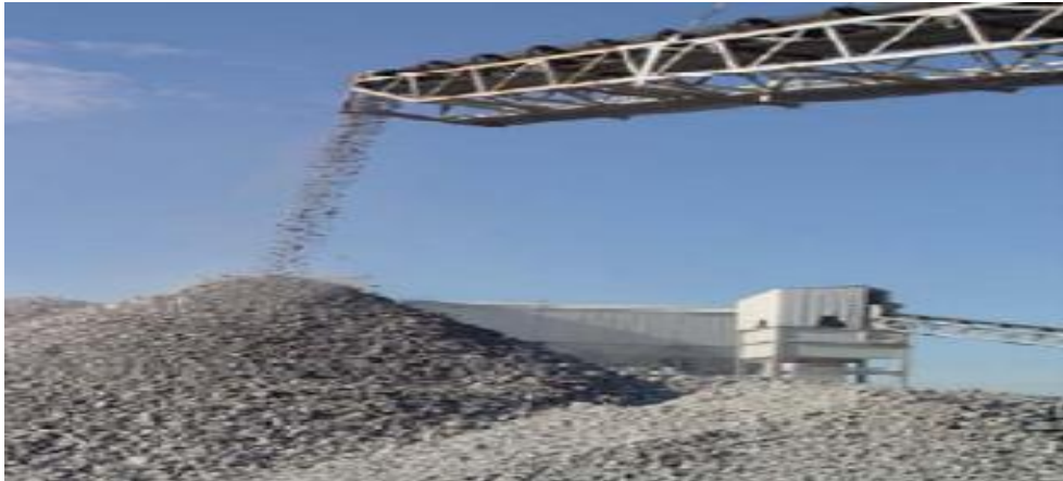
18.2. Central de reciclaje: transformación del hormigón en áridos
