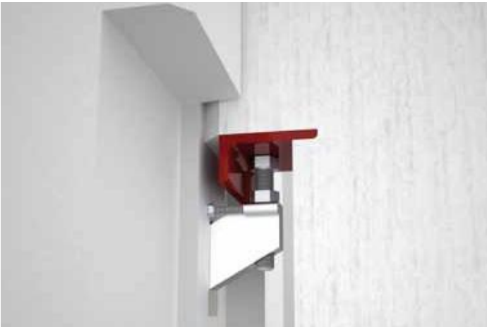
12.1. Ejemplo conexión de apoyo, Ref. Tecnyconta
