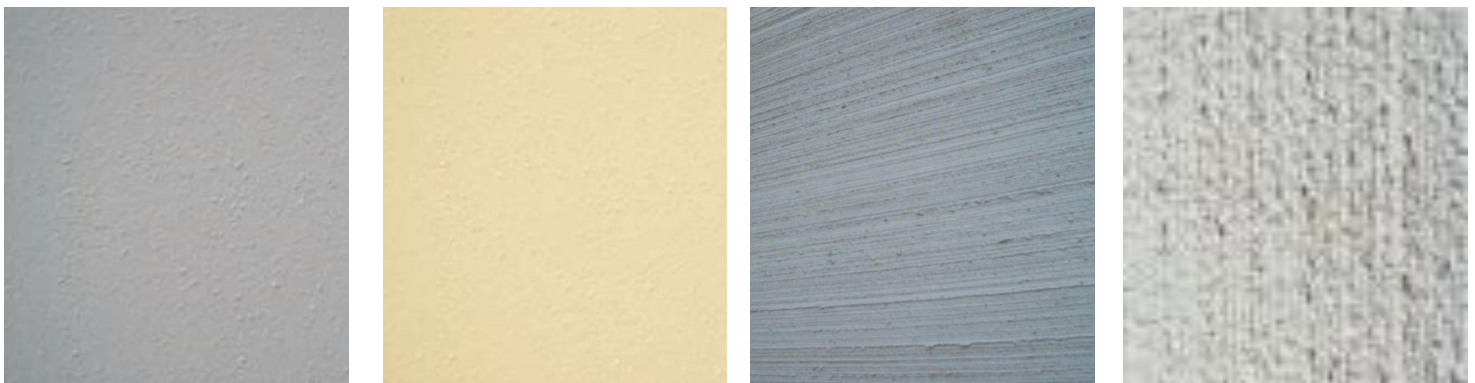
11.3. Tipos de acabados (fratasado y rayado). Ref. Prevalesa
