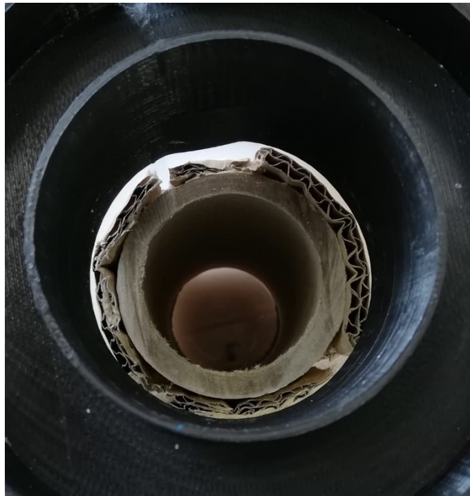
Figura 10: Tubs per evitar la deformació del depòsit interior
