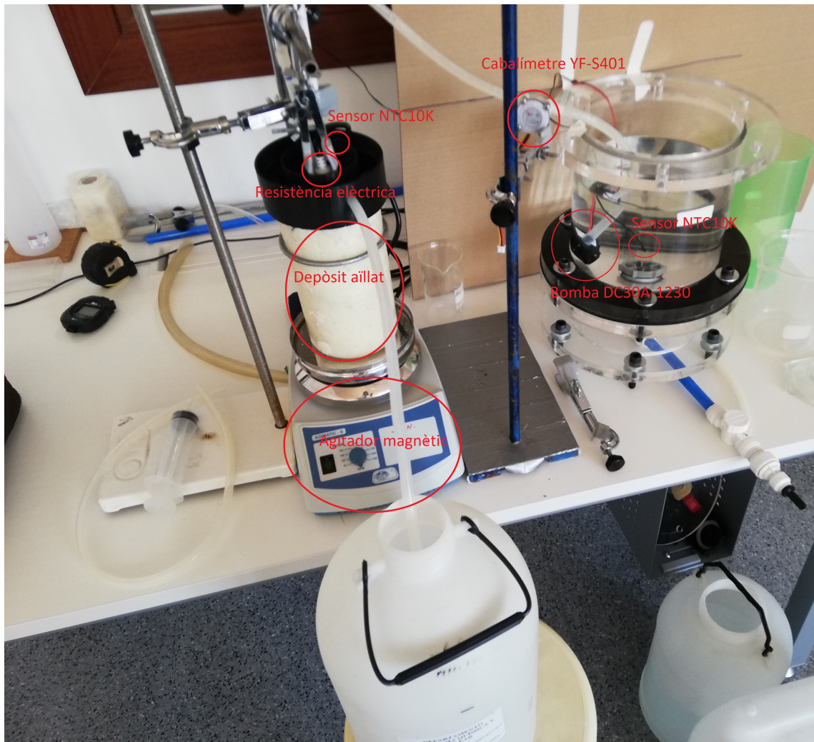
Figura 20: Muntatge de la planta de treball
