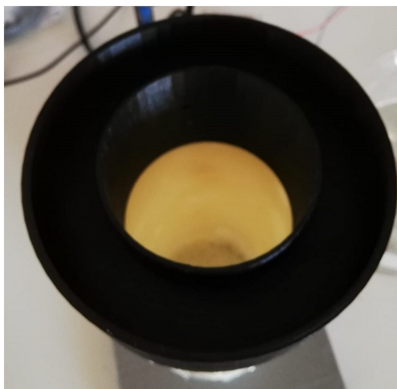
Figura 4: Segona peça impresa en 3D. Feta amb material d'àcid polilàctic(PLA)
