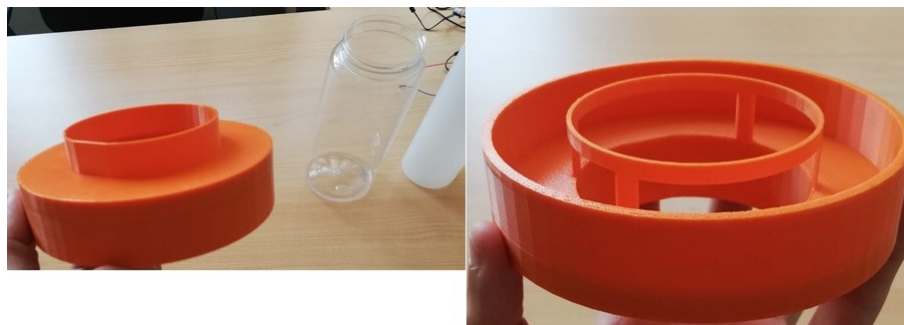
Figura 3: Primera peça impresa en 3D. Feta amb material d'àcid polilàctic (PLA)
