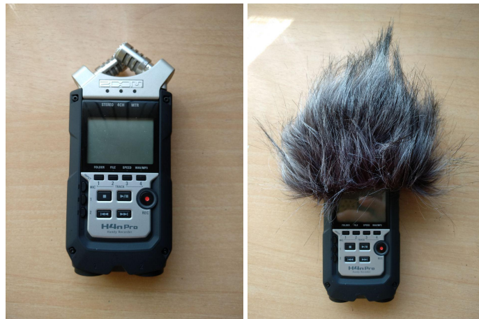
Figura 2.3: A la izquierda se observa la grabadora de mano que se ha utilizado. A la derecha se observa la grabadora con el paravientos.
