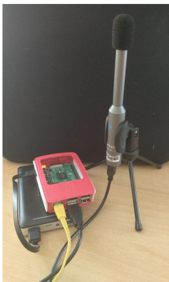
Figura 2.4: Montaje de la Raspberry con la batería y el micrófono USB.
