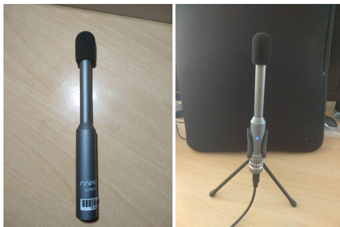
Figura 2.2: Micrófono MiniDSP UMIK-1. A la izquierda muestra el micrófono con la pantalla antivientos. A la derecha se tiene el micrófono con el soporte y conectado mediante USB.
