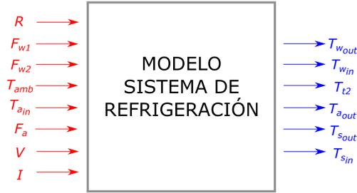
**Figura 5.27:** Entradas y salidas del sistema de refrigeración de un sistema  $\mu$ -CHP.
