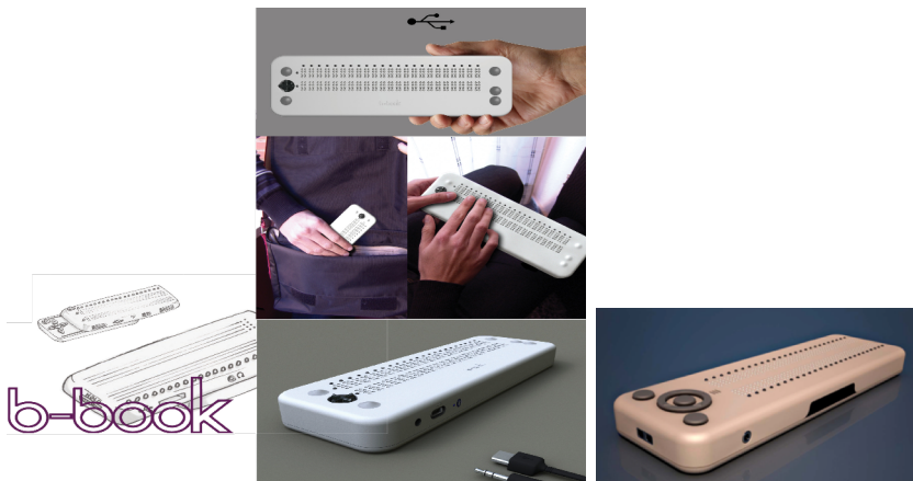
Figura 60. Modelo virtual y prototipo táctil del lector braille “b-book”, desarrollado para su manipulación por usuarios invidentes. Autor Mikel del Río Vera en su Tesis del máster Ingeniería del Diseño de la ETSID, 2014.
