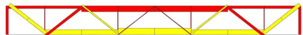
Figura 2.5-28. Diagrama de esfuerzos axiales de la viga Warren de luz L: 14.0 m y canto H: 1.4 m.
