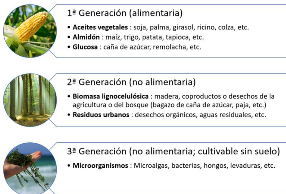
Figura I.2.4. Clasificación de los polímeros de origen biológico según el origen de la biomasa.
