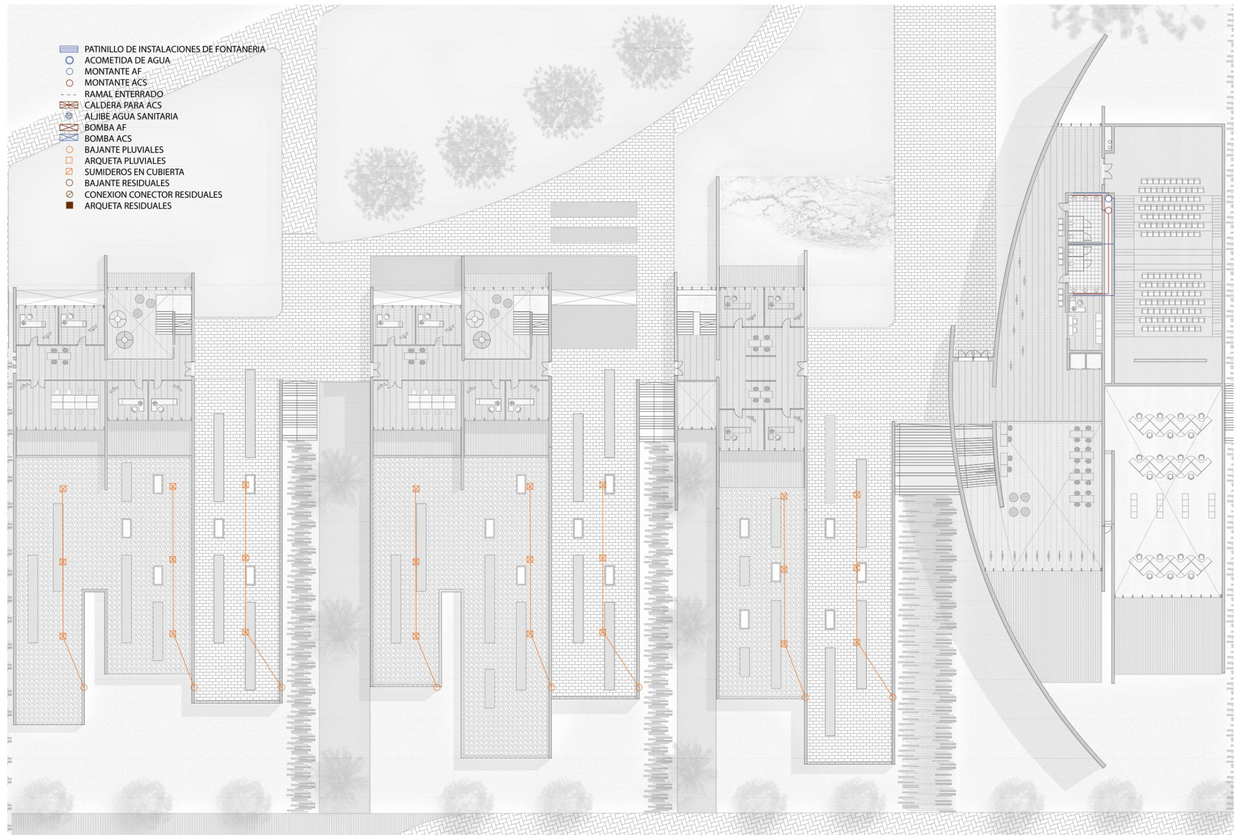
Figura 2.48 – Esquema de insatlaciones de fontaneria y saneamiento en planta primera - E: 1/300
