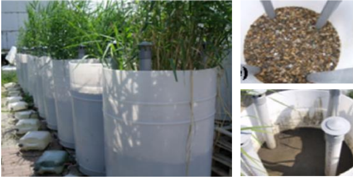
Figura 8. Lechos de carrizo en sistemas a escala piloto en Grecia.
