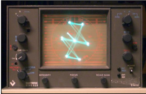
Test de barras de color visto mediante vectorscopio.
