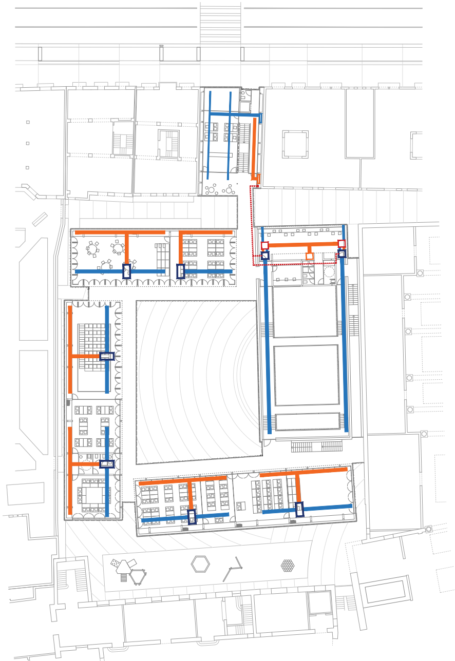
Planta primera - Climatización
