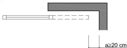
Figura 2.1 Holgura para evitar atrapamientos
