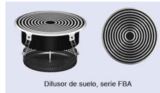
En la difusión de aire por desplazamiento a través de unidades de suelo, el aire se impulsa a baja velocidad, de forma que la vena de aire alcance una altura máxima de unos 0,6 a 0,7 m sobre el suelo. Como a esta altura prácticamente no se habrá producido la mezcla entre aire impulsado y aire ambiente, el primero estará a menor temperatura que el segundo, cayendo hacia el suelo y produciéndose la inundación de aire frío a lo largo del mismo.
