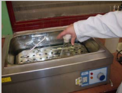
Enfriamiento del Agar hasta obtener la temperatura de 45°C
