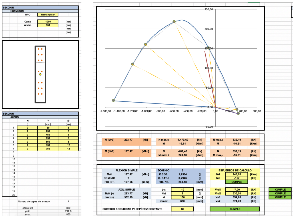
(Imagen 4.102. ELU, comprobación de resistencia L.C.N.+ Reforzado)
