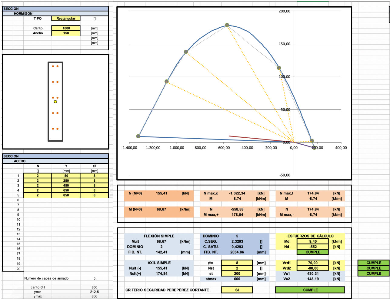
(Imagen 4.120. ELU, comprobación de resistencia L.C.S. Compresión)
