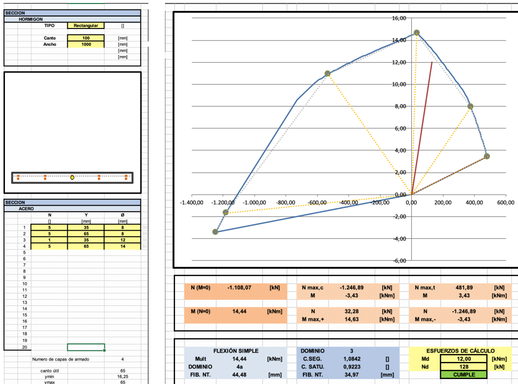
(Imagen 4.81. ELU, comprobación de resistencia LSS- Refuerzo)
