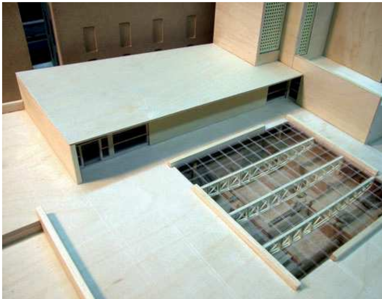
Figura 132. Vista de la maqueta de ideación inicial, con las tres cerchas de gran dimensión.
