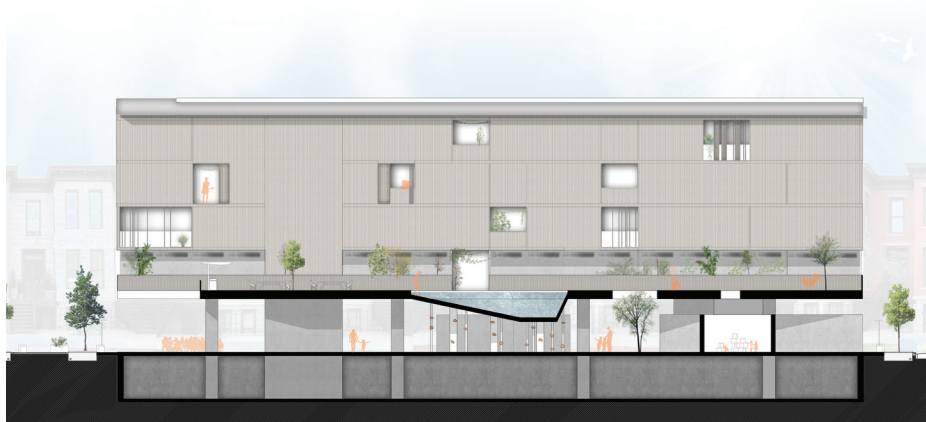
Fig 24. Espacio de la planta baja libre como atracción y lugar de encuentro. Además guarda una relación en sección con el espacio semi-público superior.
