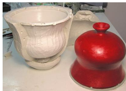
Fig. 18. Pieza de cera maciza y molde.
