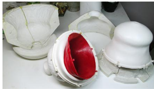
Fig. 23 y 24. Despiece del interior y el exterior del molde.
