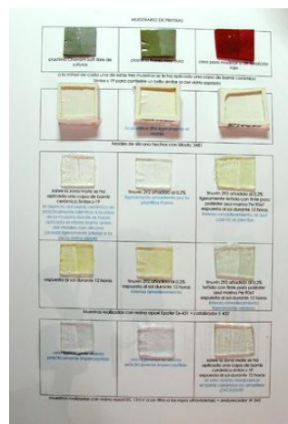
Fig. 26. Diferentes muestras para evaluar el comportamiento de los materiales al someterlos a sencillos test de envejecimiento.
