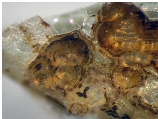
16. Imagen obtenida con el microscopio estereoscópico (20X) Detalle de la superficie de una muestra de la lámpara 2945 en la que se aprecia el oscurecimiento de la superficie.
