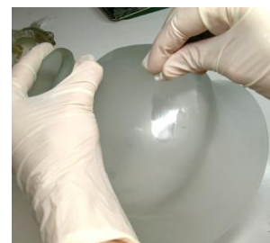
Fig. 35. Finalmente se aplica una última capa de resina con muñequilla.
