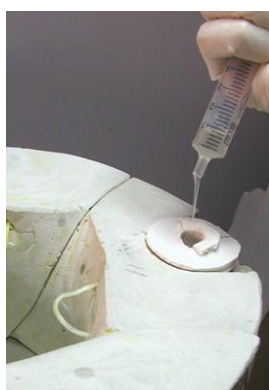
Fig. 27. Inyección de la resina por los orificios hechos entre las dos capas de silicona.
