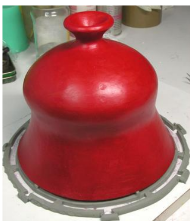
Fig. 13. La superficie de la cera queda completamente lisa, y bajo la boca está diseñado el sistema de ensamblaje del futuro molde.
