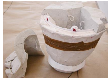
Fig. 22. Se aplica de nuevo una piel de silicona en el interior y se vuelve a realizar un contramolde rígido dividido en piezas para poder ser extraído del interior.
