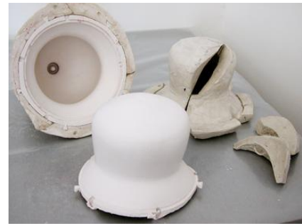
Fig. 23 y 24. Despiece del interior y el exterior del molde.
