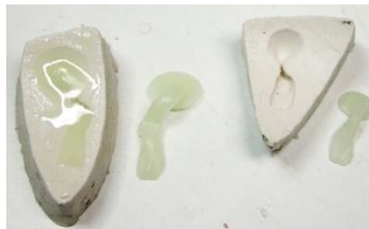
Fig. 6. Reproducción de las asitas con moldes sencillos de silicona y resina epoxi.
