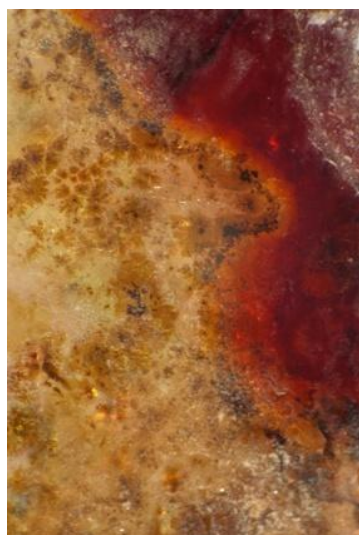
20. Imágenes obtenidas con el microscopio estereoscópico (20X). Iluminación con luz directa (A) y luz transmitida (B). Detalle de una muestra sin contextualizar que presenta tinción por contaminación.
