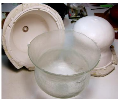
Fig. 29. Desmoldeo de la pieza de resina transparente.
