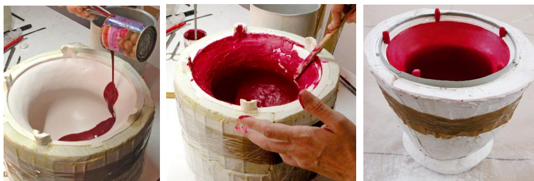
Fig. 19, 20 y 21. Aplicación de una capa fina de cera líquida sobre el interior del molde.
