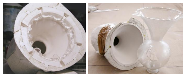
Fig. 42 y 43. A base de dar vueltas al molde se distribuía la resina uniformemente, aunque algunas de estas piezas salieron defectuosas y hubo que repetir las.
