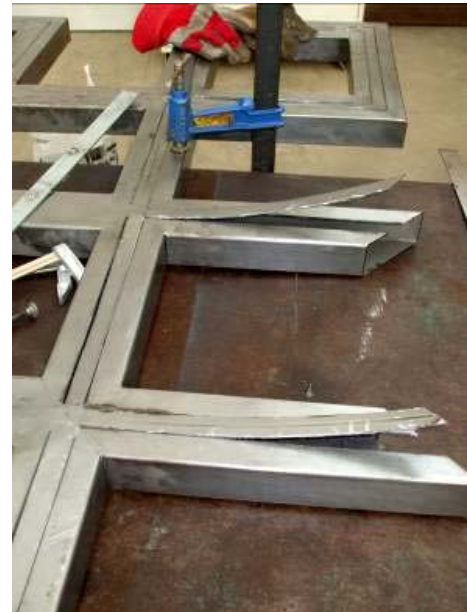
Corte con maquina radial de la canaleta, donde se introducirán los objetos móviles.
