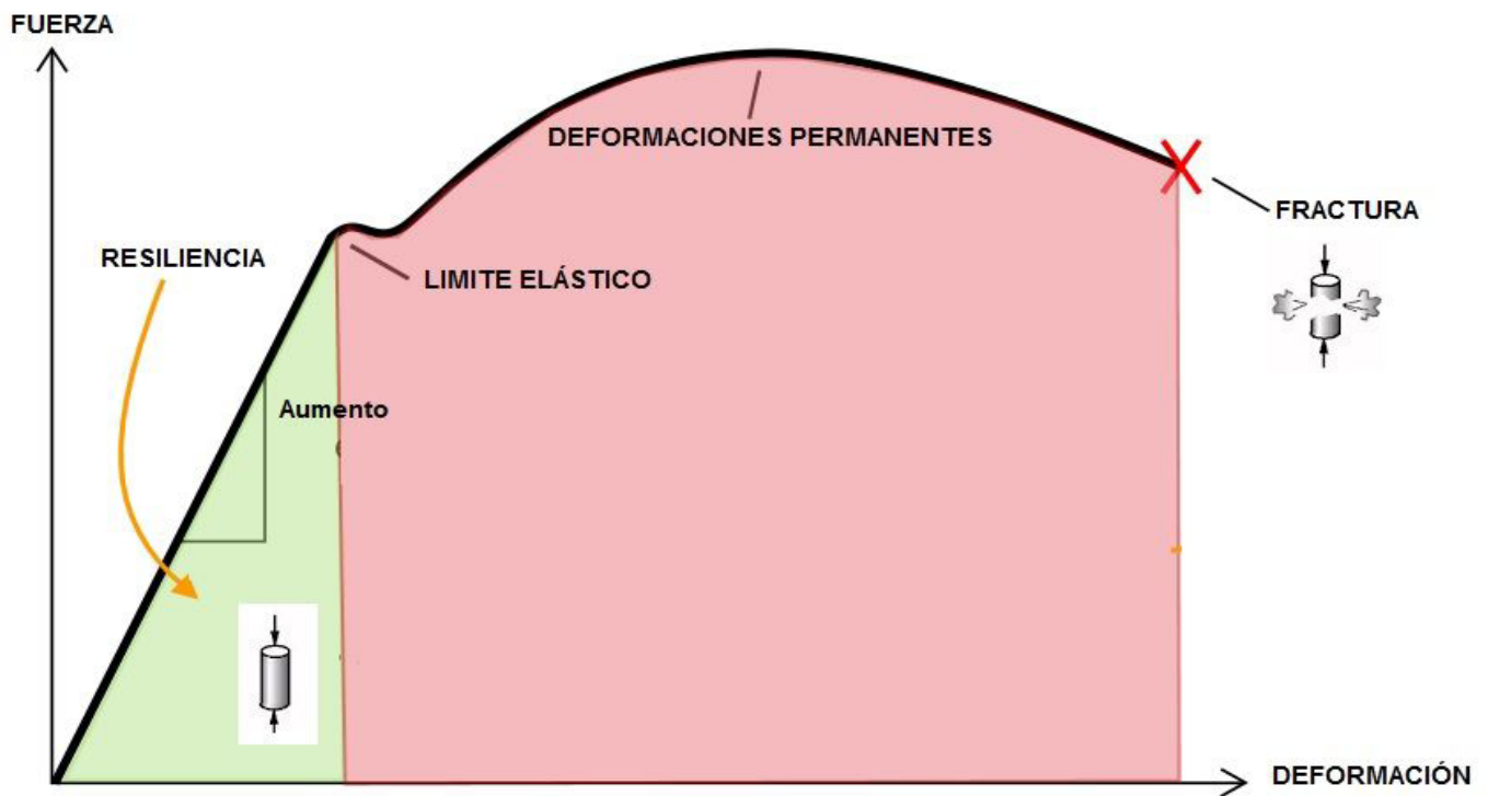
FIGURA 16: Diagrama de la ley de Hooke donde se muestra en verde la fase elástica y por lo tanto la resiliencia y en rojo la fase plástica la tenacidad la energía del verde y rojo hasta el punto de rotura.
