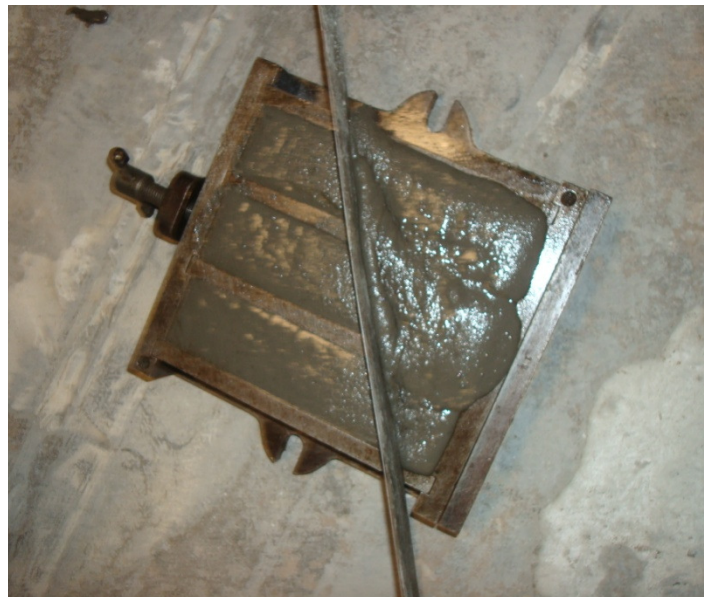
* Imagen 3.11. Alisado de la superficie de la probeta
