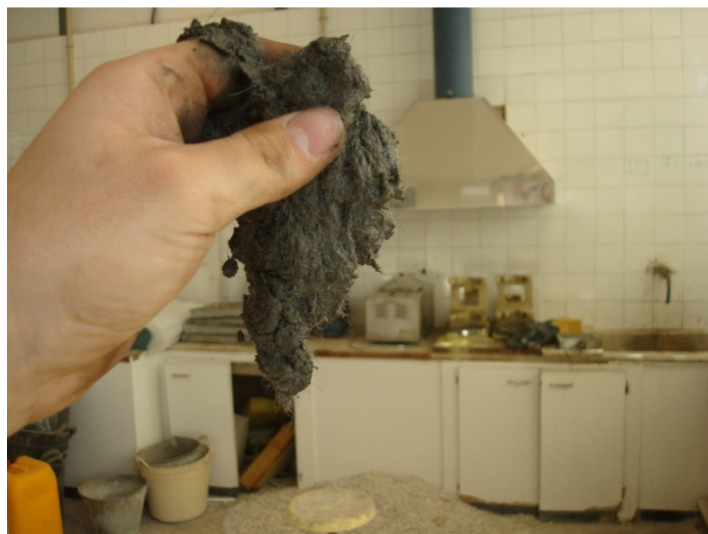
* Imagen 4.2. Corresponde a una amasada de trabajabilidad Nivel 3 (Dificultad Muy Alta)
