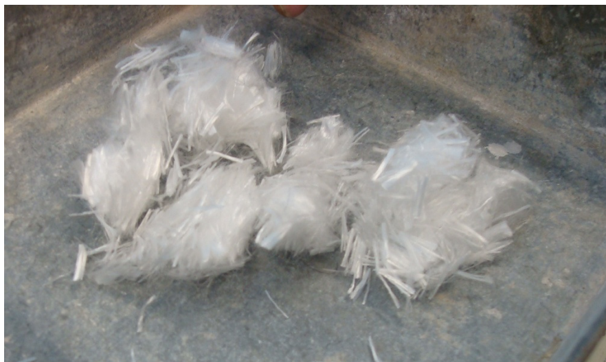
* Imagen 3.7 Fibra de PP multilamento Sikafiber M-12
