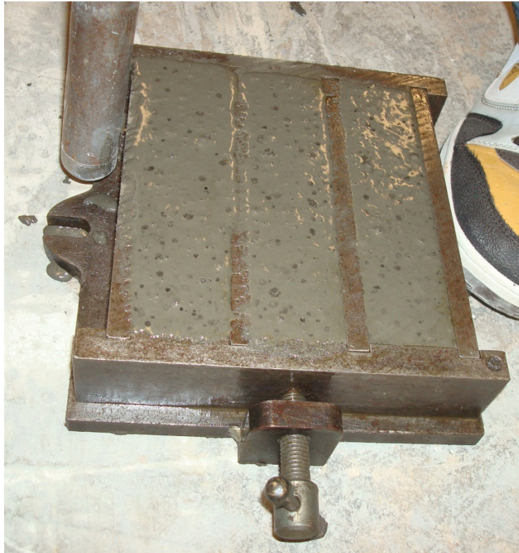
*Imagen 3.11. Vibrado de las caras del molde
