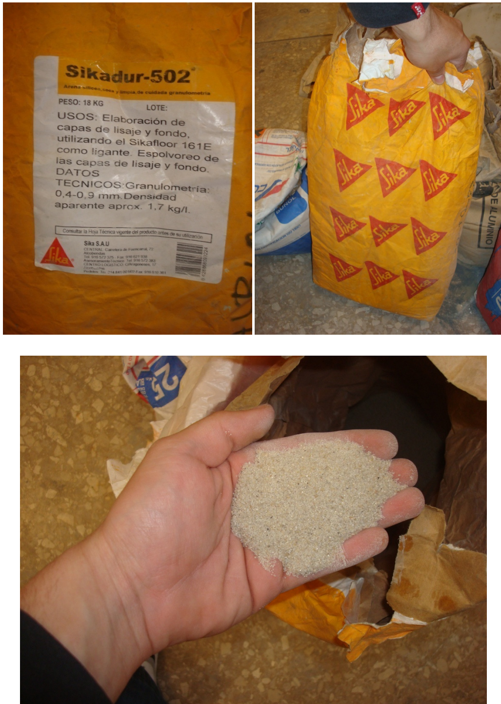
* Imágenes 3.1, 3.2, 3.3. Arriba izquierda portada saco 18 kg árido Sikadur-502, arriba derecha reverso saco y abajo apreciación de la finura del árido seleccionado
