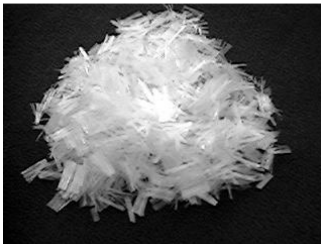
* Imagen 7. Fibra de polipropileno multifilamento
