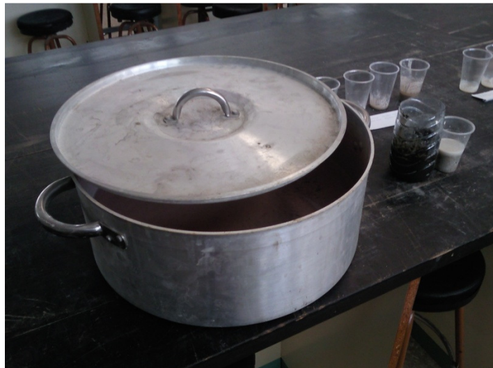
*Imagen 3.15. Balde lleno de agua donde se sumergen las probetas para meterlas al horno
