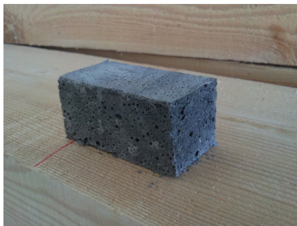
*Imagen 3.18. Parte resultante del ensayo de flexotracción, objeto de ensayo a compresión.
