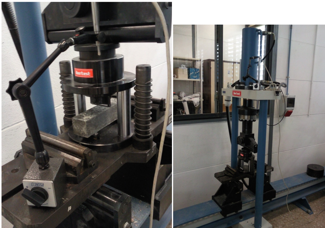
*Imagen 3.16. Maquinaria utilizada para la realización de ensayos a flexotracción
