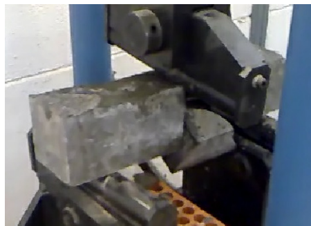
Imagen 2. Rotura de probeta a flexión en tres puntos.
