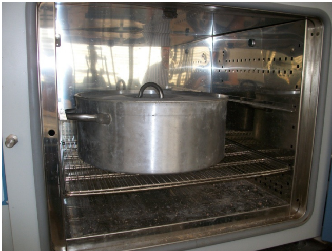
Imagen 37. Probetas sumergidas en agua dentro de olla a 60°C.
