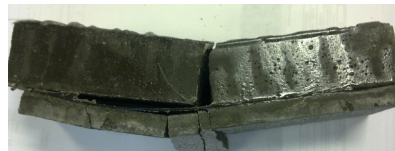
Imagen 4. Probeta 2 después de rotura a flexión.
