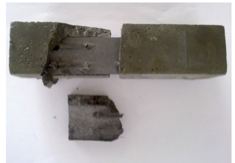
Imagen 3. Probeta con 1 lámina de fibra de carbono con 8 orificios.
