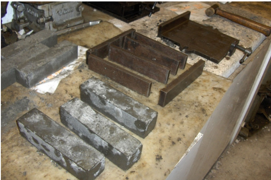
Imagen 32. Probetas desmoldadas y listas para etiquetar.
