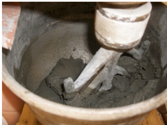
Imagen 21-22. Fabricación del hormigón en amasadora planetaria de mortero.
