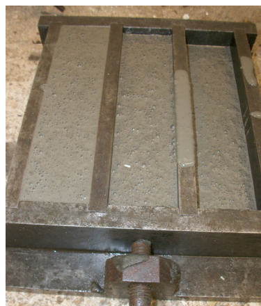
Imagen 2. Preparación de las láminas de hormigón.
