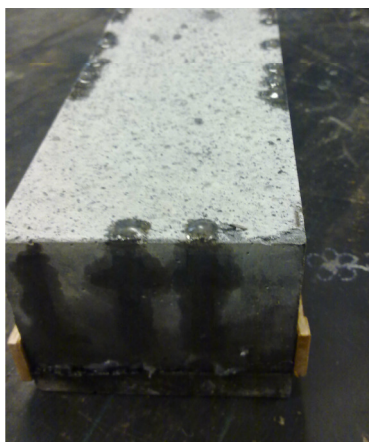
Imagen 2. Probeta antes de la rotura. Unido con epoxi.
