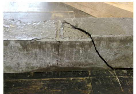
Imagen 3. Rotura de la probeta a cortante
