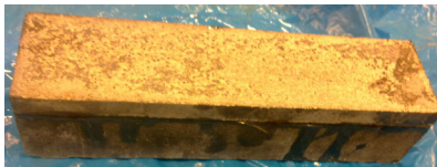
Imagen 1. Probetas unidas con epoxi.
