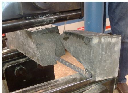
Imagen 2. Rotura de probeta con barra de acero.
