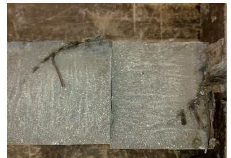
Imagen 3. Probeta tras la rotura. Posición de la tela.
