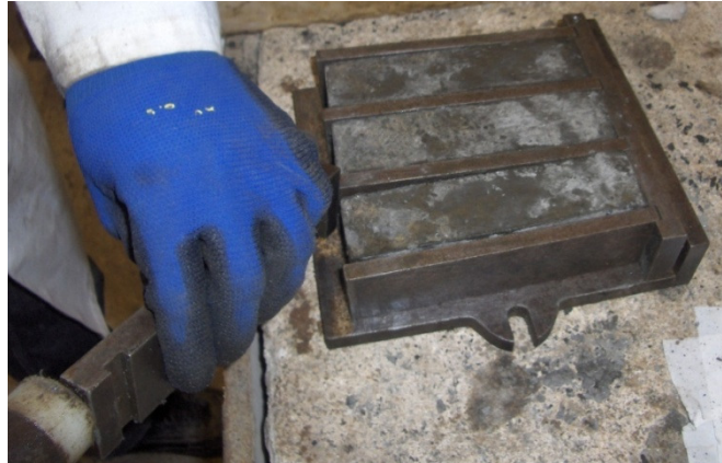
Imagen 31. Pequeños golpes para la separación de las probetas del molde.
