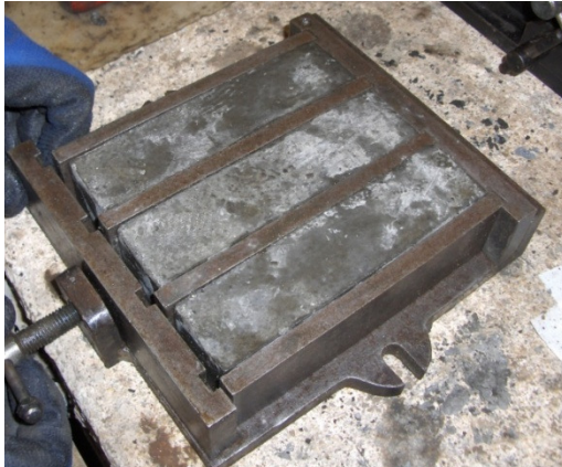
Imagen 30. Desmoldado de probetas.
