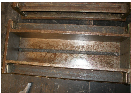
Imagen 1. Patrón. Probeta con barra de fibra de carbono.
