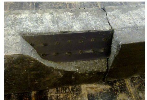
Imagen 3. Probeta tras la rotura. Lámina de fibra de carbono.
