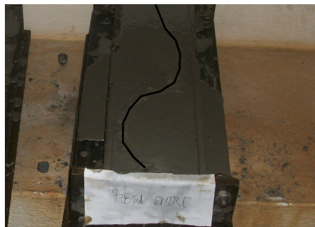
Imagen 2. Probeta en cámara húmeda. Posición de la tela.
