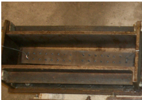
Imagen 1. Probeta con lámina de fibra de carbono.
