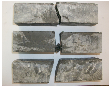
Imagen 2. Probetas después de rotura a flexión.
