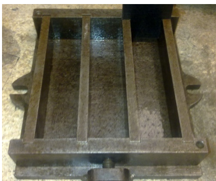
Imagen 2. Molde de probeta 160x40x40 mm.
