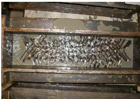
Imagen 1. Probeta con tela de fibra de carbono.
