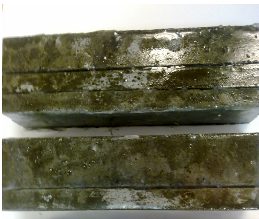
Imagen 1. Probetas unidas con epoxi.
