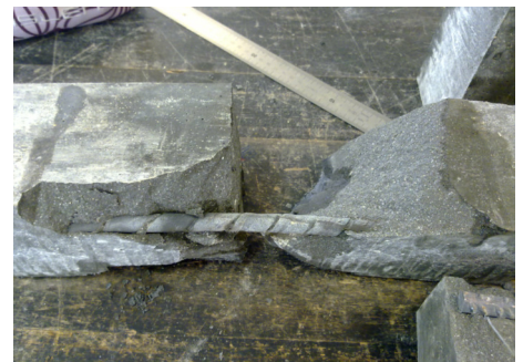
Imagen 3. Rotura de la probeta con barra de fibra de carbono.
