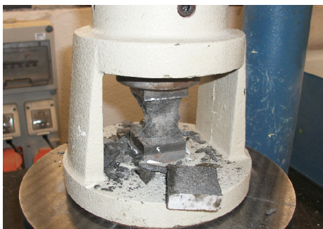
Imagen 1. Patrón. Rotura a compresión.
