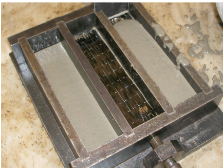
Imagen 1. Vertido en molde y colocación de láminas.
