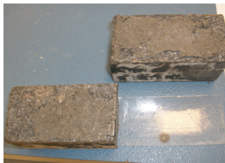
Imagen 2. Probeta con 1 lámina de polietileno.
