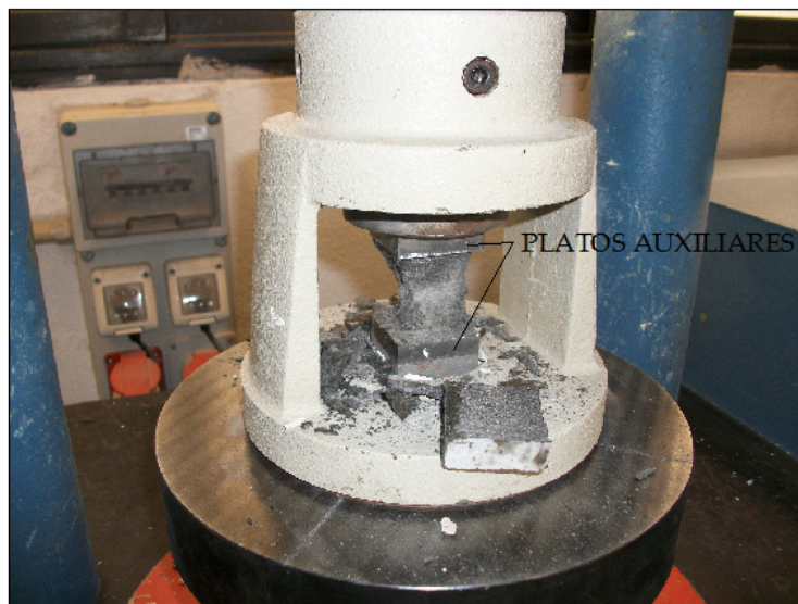
Imagen 42. Platos auxiliares utilizados para el ensayo a compresión.
