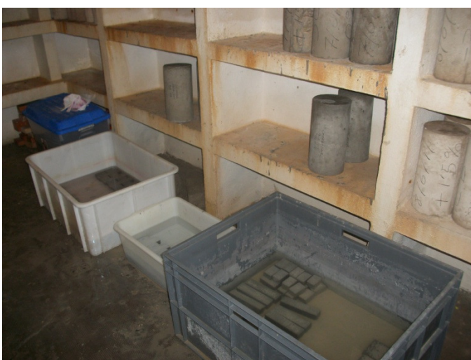
Imagen 35. Probetas en cámara húmeda sumergidas en agua.
