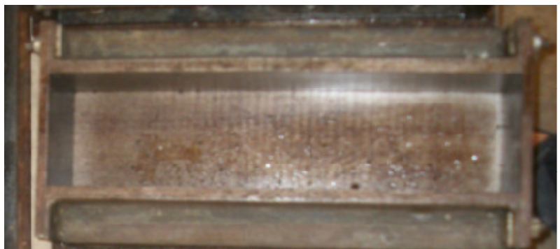
Imagen 3. Molde de probeta de 400x100x100 mm.
