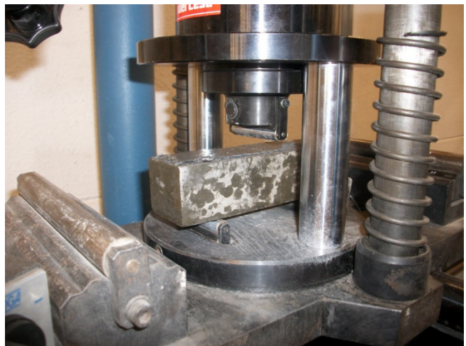
Imagen 41. Probeta preparada para la rotura a flexión.
