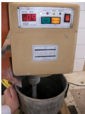
Imagen 21-22. Fabricación del hormigón en amasadora planetaria de mortero.
