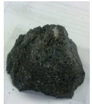
Imagen 6. Probeta patrón después de rotura a compresión.
