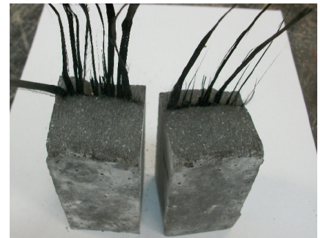
Imagen 3. Deslizamiento de la tela de fibra de carbono.
