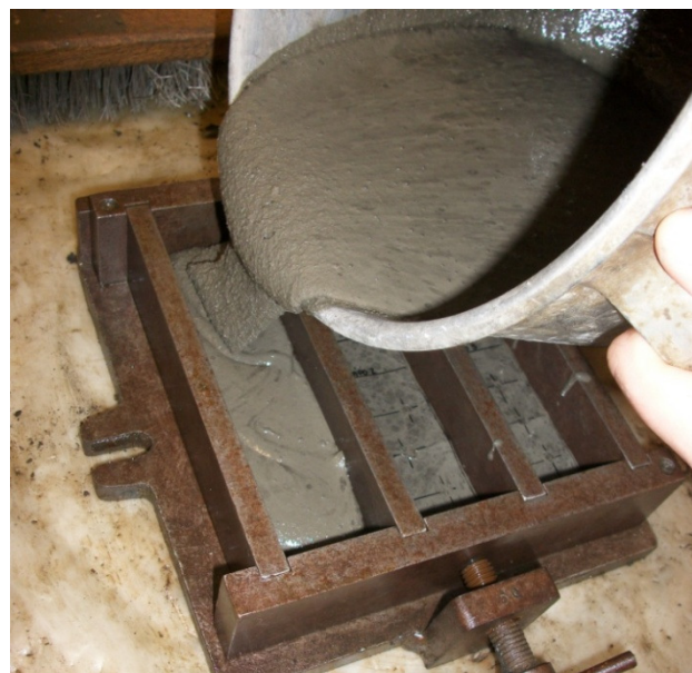
Imagen 25. Vertido en molde con colocación de láminas de polietileno.
