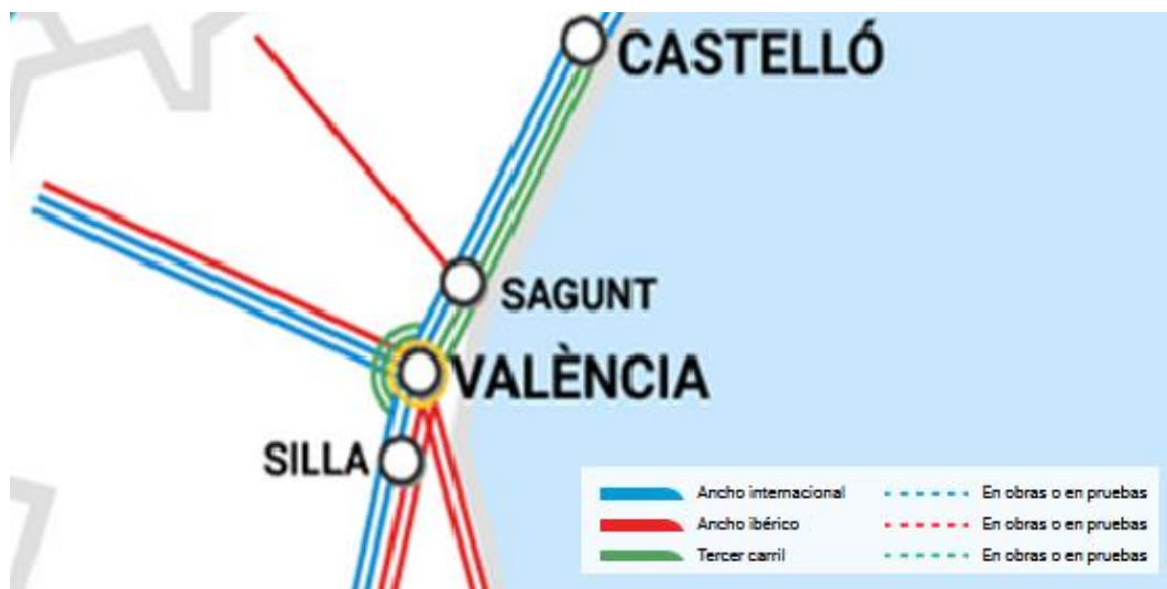
Figura 3. Fase 2: Cambio de un carril a ancho internacional. Fuente: (Asociación Valenciana de Empresarios, 2019)
