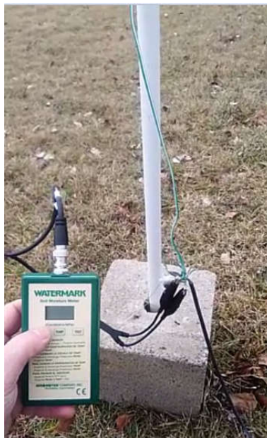
Figura 2.2.Sonda de humedad, medición de humedad manual.
