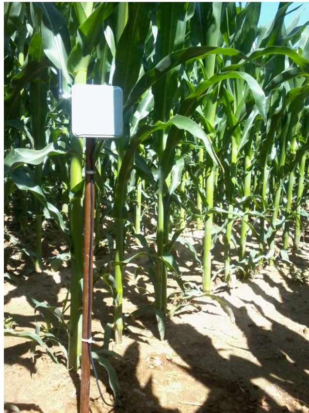
Figura 4.1. Nodo 868 con sonda de humedad watermark de irrometer en cultivo de maíz.
