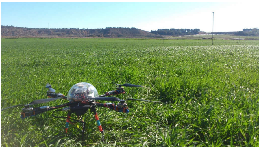
Figura 2.5. Dron con cámara NGB para análisis de índices de Vegetación en el campo de ensayo.
