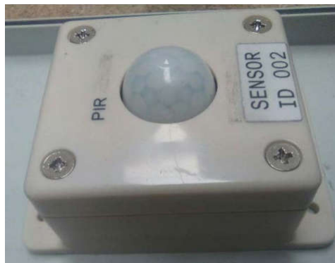
Figura 4.28. Envoltente del Nodo y lente del sensor PIR.
