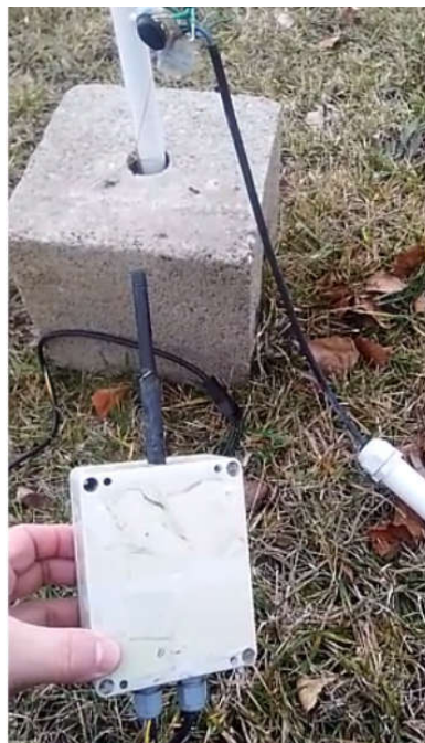
Figura 2.3. Sonda de humedad conectada al módulo de radio 868MHz.
