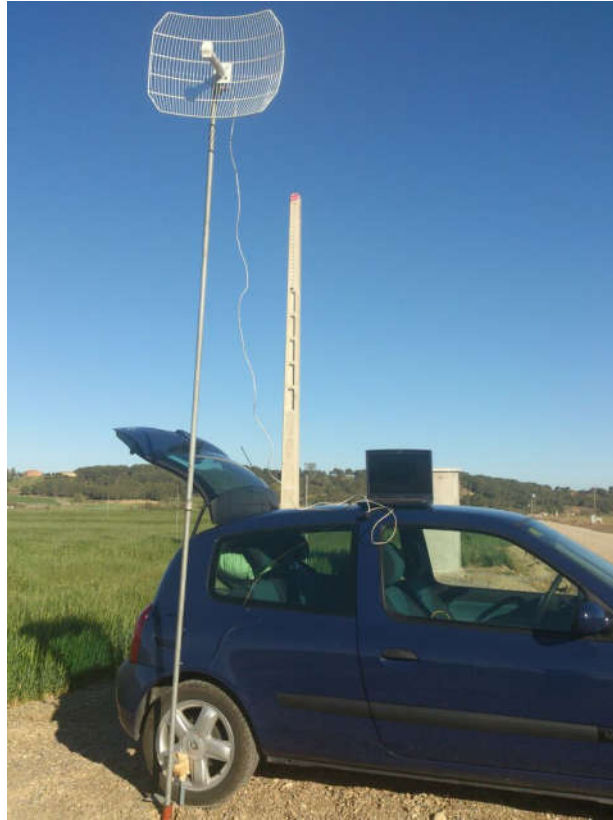
Figura 4.15. Despliegue WiFi en red Ad Hoc.
