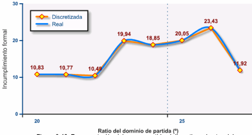
Figura 6.46: Representación del error cometido al discretizar el potencial geométrico del árbol de cortes.
