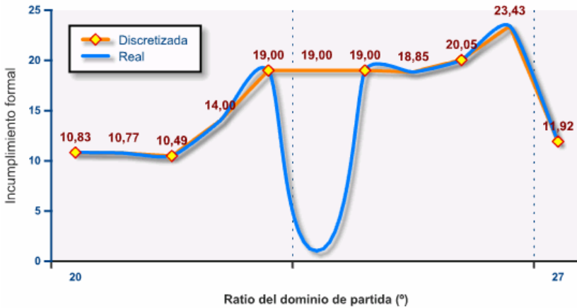
Figura 6.47: Error en la interpolación entre muestras del potencial geométrico del árbol de cortes.
