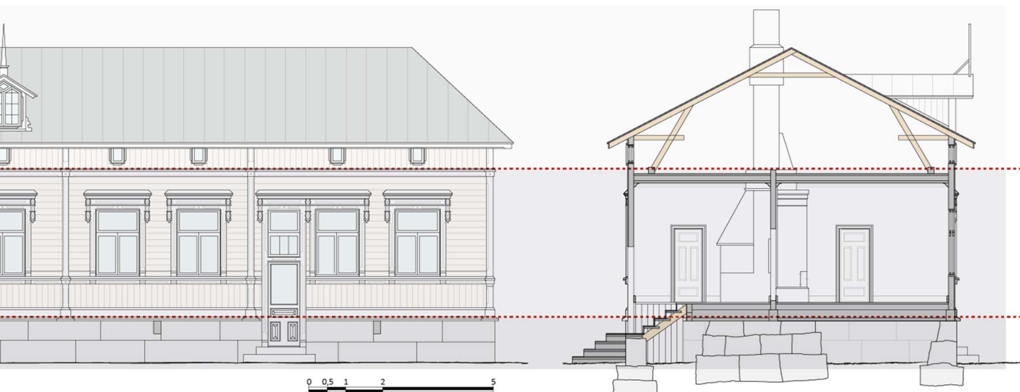
Figura 45: Fachada y sección transversal de Tammela en su configuración hipotética de principios del siglo XX. Se puede apreciar cómo la división en fajas horizontales se corresponde con la estructura. Así, el zócalo se corresponde con sótano y cimientos, el cuerpo principal con paredes y entreplanta, mientras que el remate se corresponde con el bajo techo y la cubierta (elaboración de la autora)
