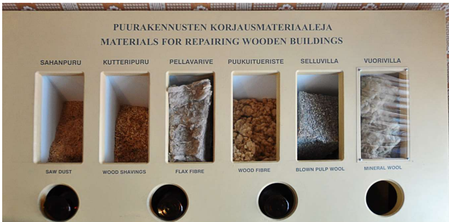
Figura 76: Diferentes materiales aislantes expuestos en Tammela (f.d.a. 26/09/2019)
