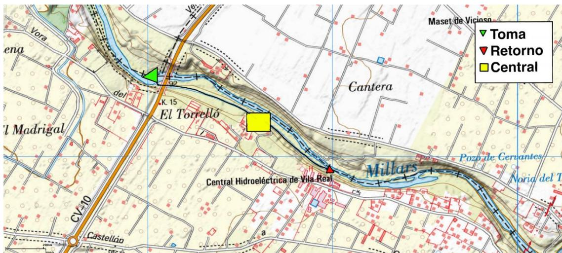
Figura 56. Diagrama de la central de Villarreal.
