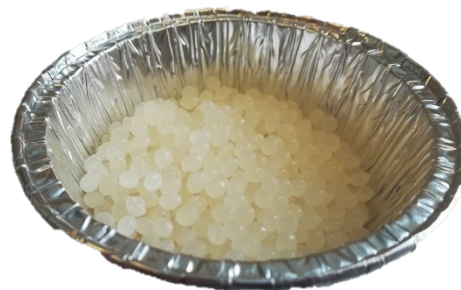
Figura 28. Imagen de la muestra de granza de material de PLA preparada para la realización del ensayo de índice de fluidez (MFI).
