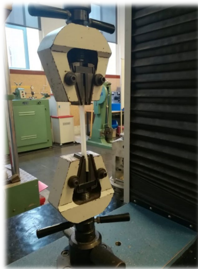
Figura 24. Fotografía con el detalle de las mordazas empleadas para la sujeción y anclaje de las probetas en el ensayo de tracción.
