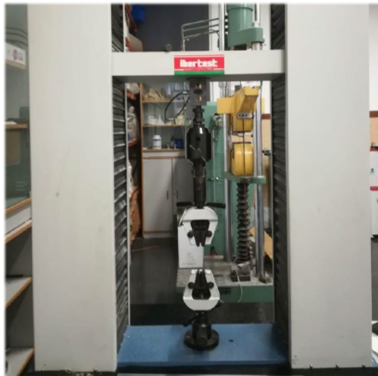
Figura 23. Fotografía de la máquina universal de ensayos ELIB 30 empleada en la caracterización de las propiedades mecánicas de PLA sometidos a diferentes ciclos de reprocesado.
