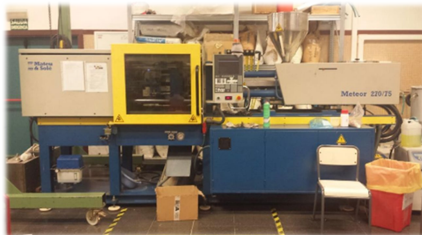
Figura 22. Fotografía de la máquina de inyección Materu & Solé empleada en la fabricación de las probetas normalizadas para su posterior caracterización.
