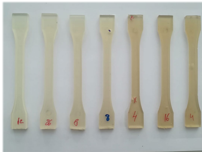
Figura 46. Fotografía de las probetas de inyección para ensayos de tracción de PLA sometido a diferentes ciclos de reprocesado. Izquierda: 0 ciclos; derecha: 6 ciclos.
