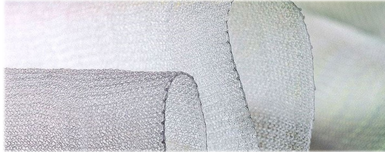
Figura 16. Fotografía de tejido textil con resistencia a la luz UV mejorada, fabricado con fibras de ácido poliláctico (PLA).
