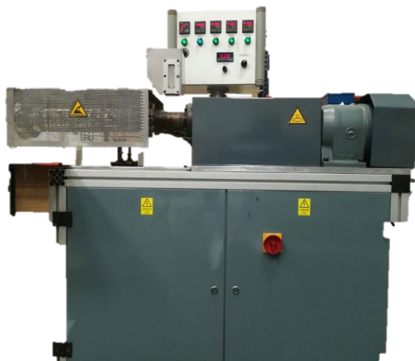
Figura 19. Fotografía de la extrusora de doble husillo co-rotante empleada en el procesado y reprocesado de PLA.
