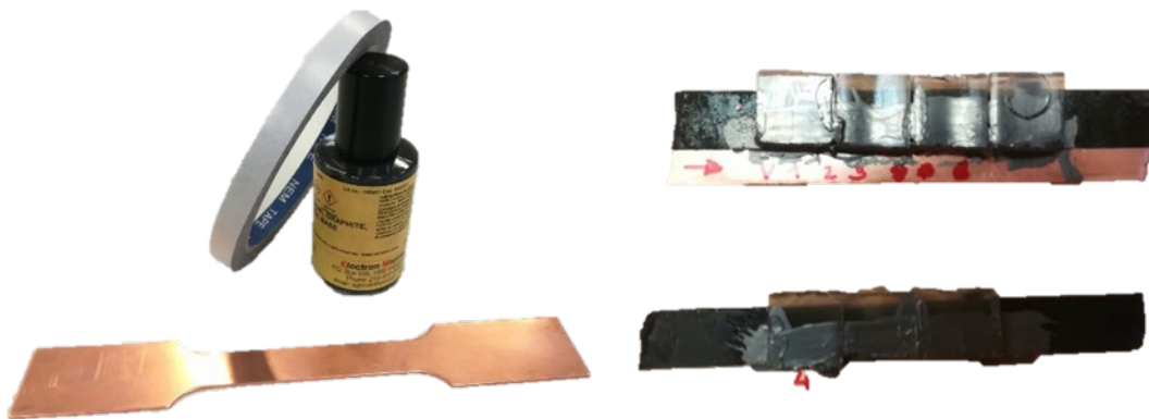
Figura 36. Fotografía de a) material empleado para la preparación de las muestras para el recubrimiento y b) muestras preparadas para su observación mediante FESEM.
