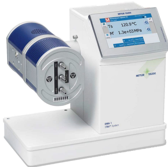
Figura 34. a) Fotografía del analizador mecánico dinámico DMA1 de Mettler-Toledo empleado en la caracterización mecánico-dinámica de PLA reprocesado.
