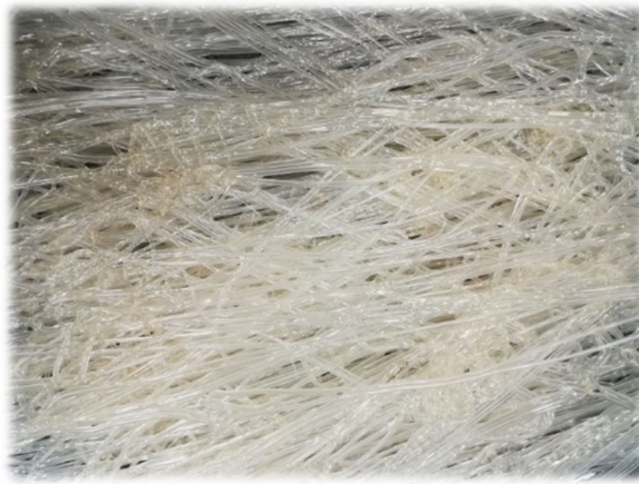
Figura 20. Fotografía de los filamentos de PLA obtenidos después del procesado/reprocesado mediante extrusión y enfriamiento en aire para evitar la hidrólisis.
