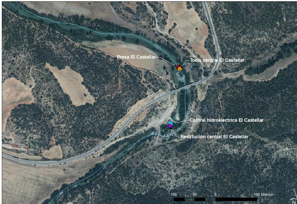
Figura 10. Ortofoto de la central hidroeléctrica de El Castellar 1:5.000
