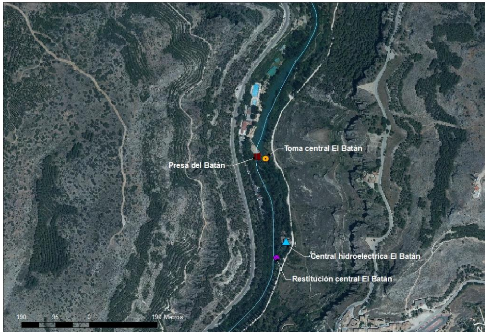
Figura 8. Ortofoto de la central hidroeléctrica de El Batán escala 1:5.000
