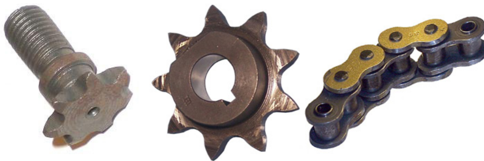
Imagen 33: Piezas de bicicleta utilizadas para el giro vdel tubo.
