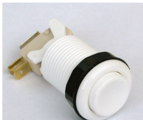
Imagen 15 y 16: joystick y pulsador o botón con el switch donde se conectan los cables que hemos soldado a la placa del teclado
