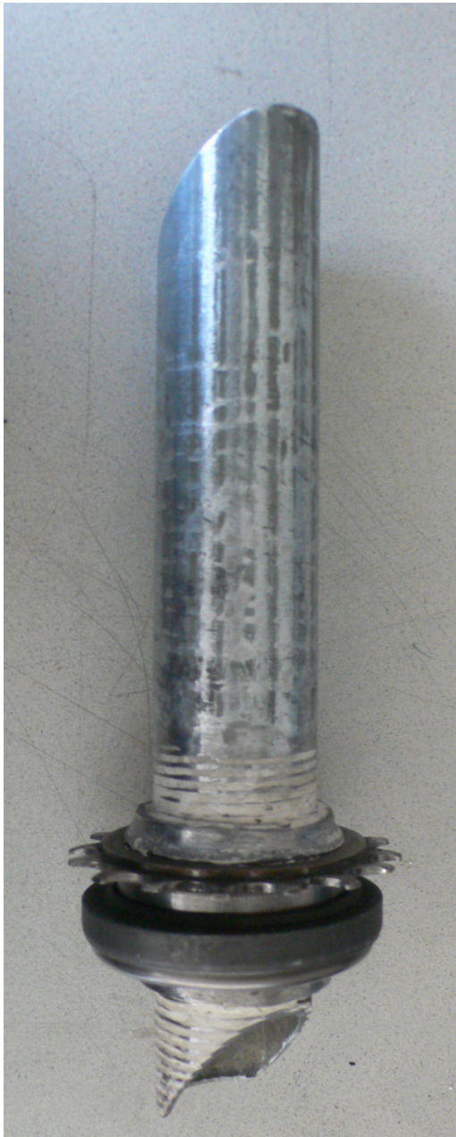
Imagen 37 y 38: Cilindro seccionado Montaje del cilindro, con el rodamiento inserto en la base
