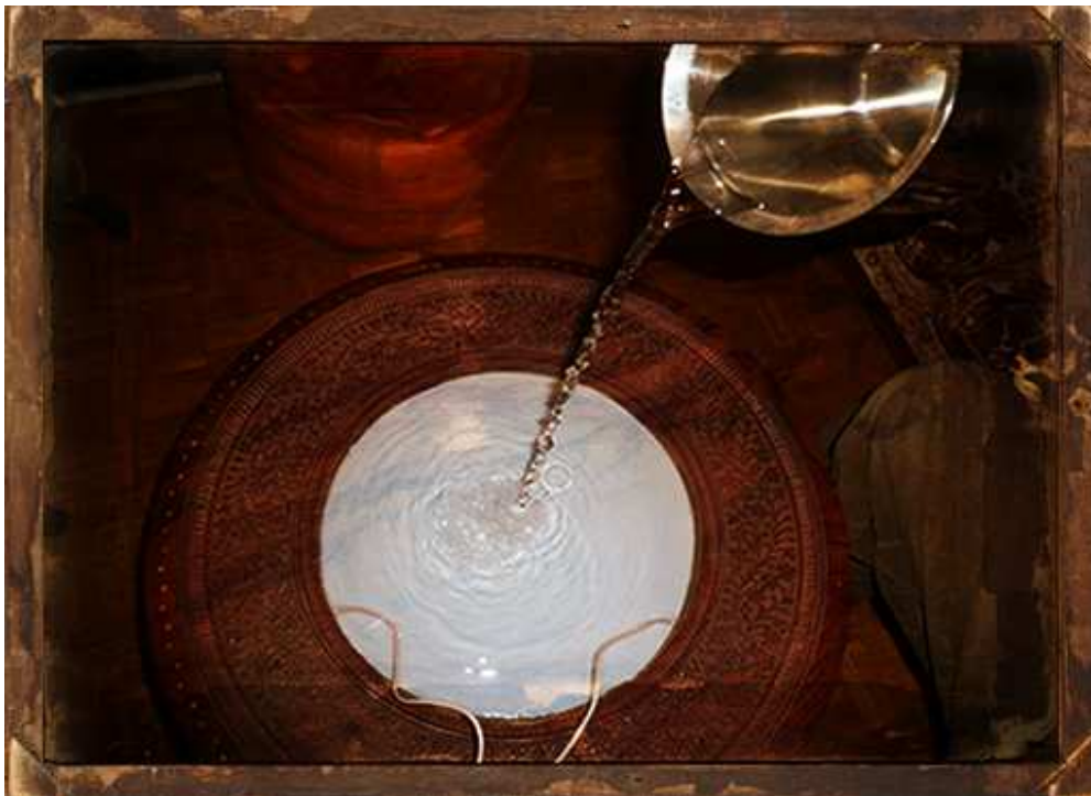
Figura nº 53: Comprobando el sellado de silicona con 2L. de agua (Seguridad)
