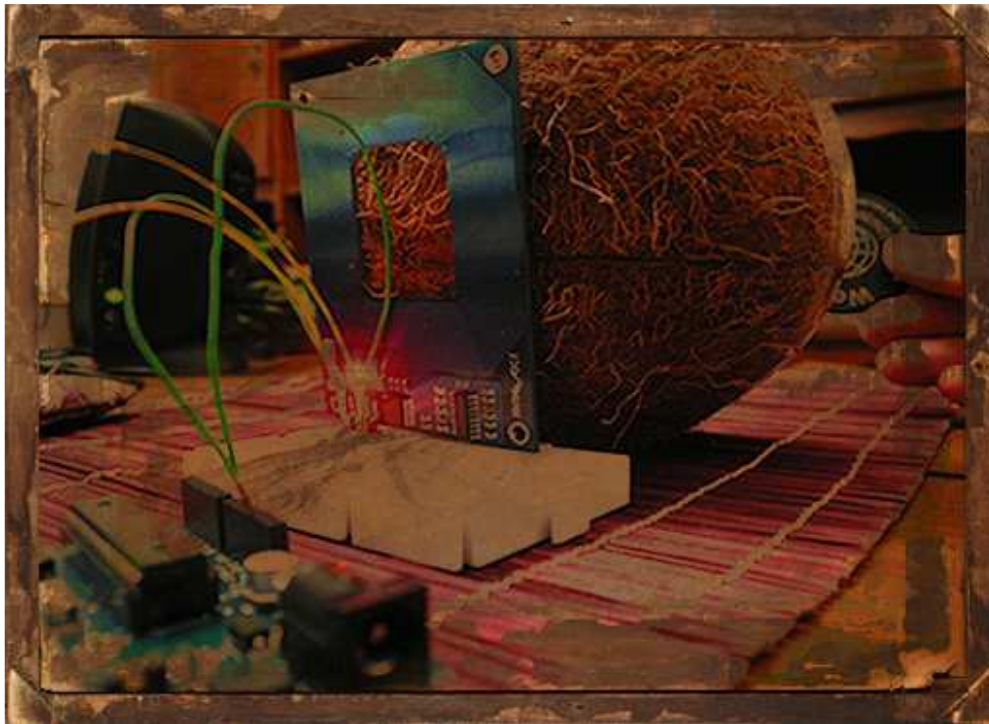
Figura nº 56: Pruebas tarjeta lectora RFID a través de coco (Arduino+RFID)
