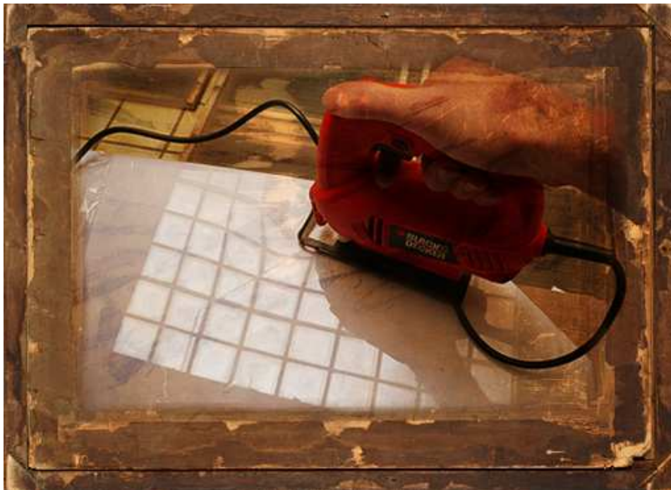
Figura nº 34: Cortando styroglass con caladora (Construcción)
