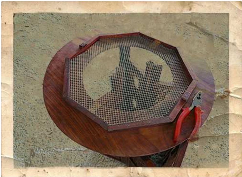
Figura nº 43: Mallado de hierro ensamblado (Pruebas de construcción)
