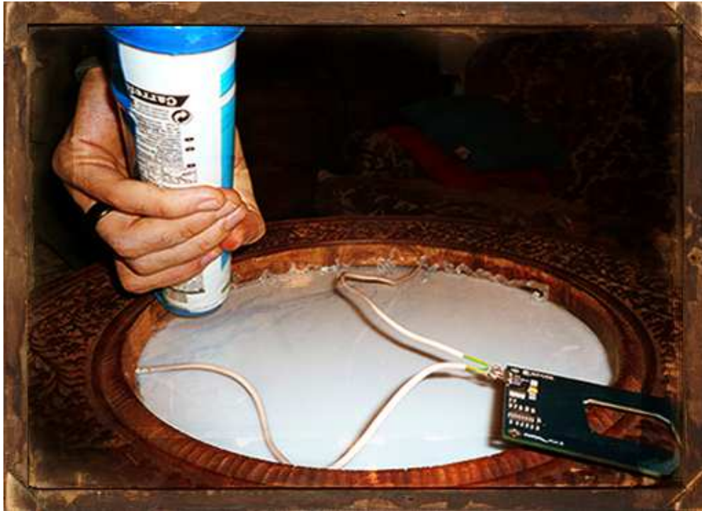
Figura nº 50: Aplicando silicona – parte exterior 1 (Seguridad)
