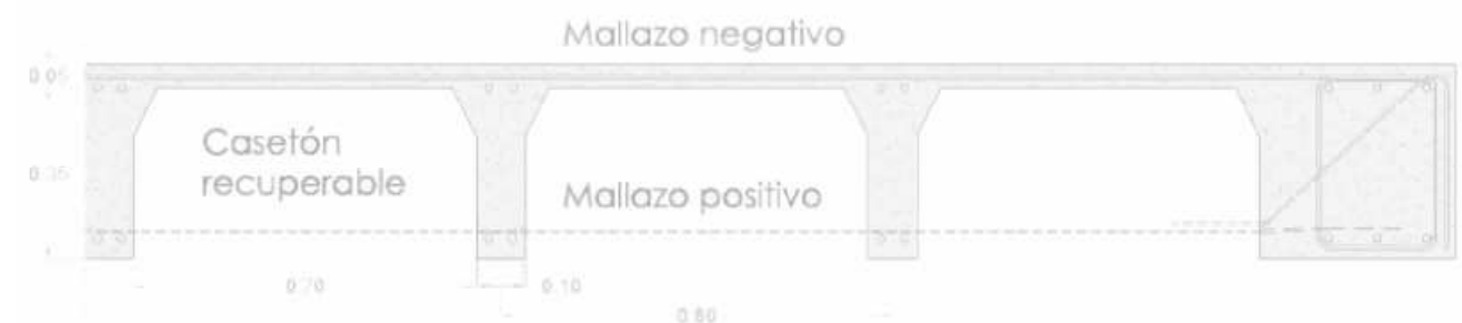
FORJADO BIDIRECCIONAL ALIGERADO CON CASETONES RECUPERABLES
