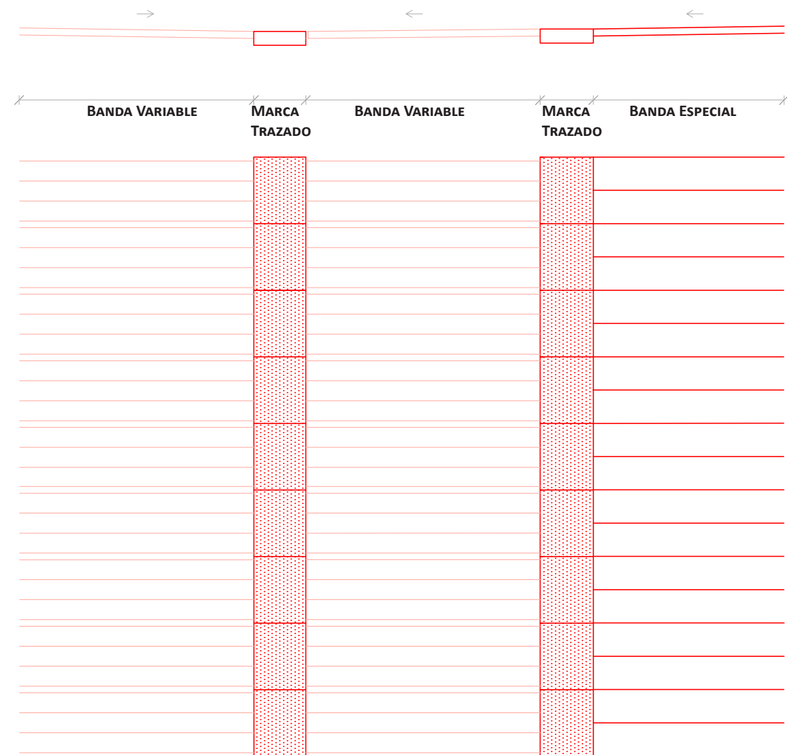
Combinación de franjas de pavimento según ámbitos, bandas de recorrido habitual y bandas especiales como aparcamiento especial o frente fachadas de los edificios singulares. Combinados en una misma sección. Una franja de circulación rodada delimitada por bordillo para delimitar el paso de vehículos en horario de carga y descarga o los vehículos especiales de los edificios institucionales.
