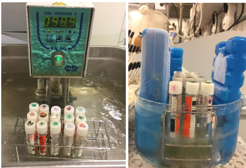
Figura 16. Imagen de baño caliente y enfriamiento cubetas de reacción para carbohidratos
