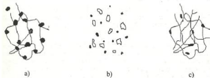
Figura 3. Efecto de la presencia de bacterias filamentosas sobre la estructura del fango activo: a) ideal, b) punta de alfiler, c) Bulking [28]
