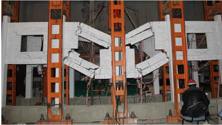
Fig. 2-14 Ensayo de pórticos de hormigón armado con muros de relleno. Foto por cortesía de Shuang Li (Instituto de Tecnología de Harbin).
