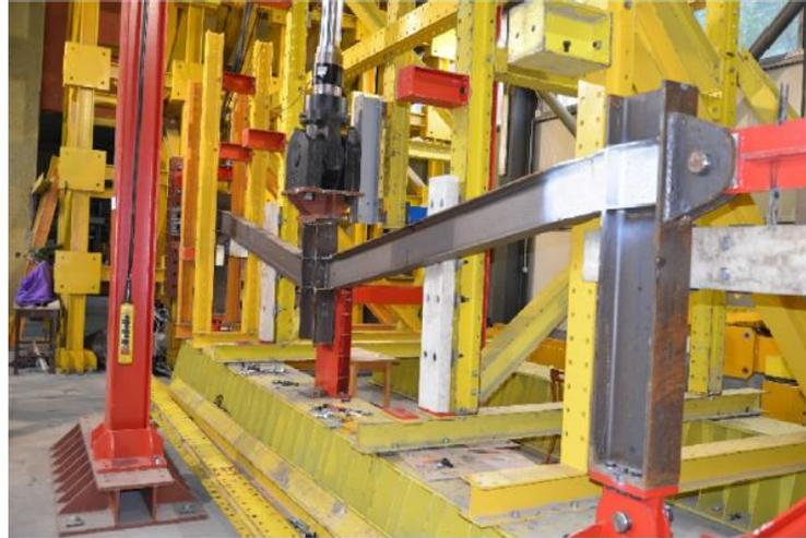
Fig. 2-9 Configuración de experimento, para estructura de acero (3 pilares y 2 vigas). Foto por cortesía de Florea Dinu (Universidad Politécnica de Timisoara).
