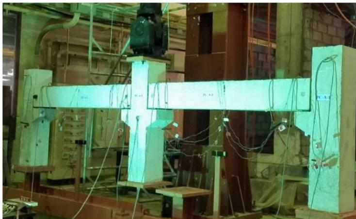
Fig. 2-12 Configuración de experimento, para hormigón prefabricado. Foto por cortesía de Hussein M. Elsanadedy (Universidad King Saud).
