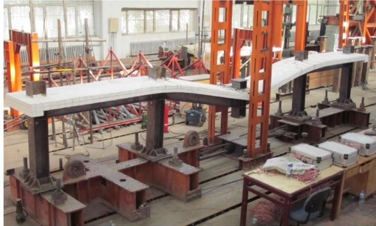
Fig. 2-13 Ensayo de pórticos de metálicos con losa de hormigón. Foto por cortesía de Lanhui Guo (Harbin Institute of Technology).
