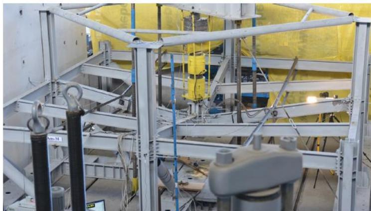
Fig. 2-15 Ensayos de pórticos en 3D de acero estructural. Foto por cortesía de Florea Dinu (Universidad Politécnica de Timisoara).
