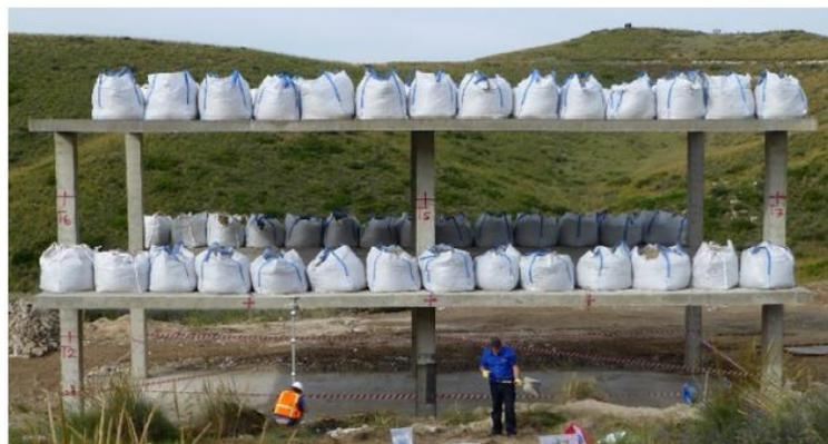
Fig. 2-16 Ensayo de una estructura de hormigón armado. Foto por cortesía de Mario Bermejo (Universidad Politécnica de Madrid).
