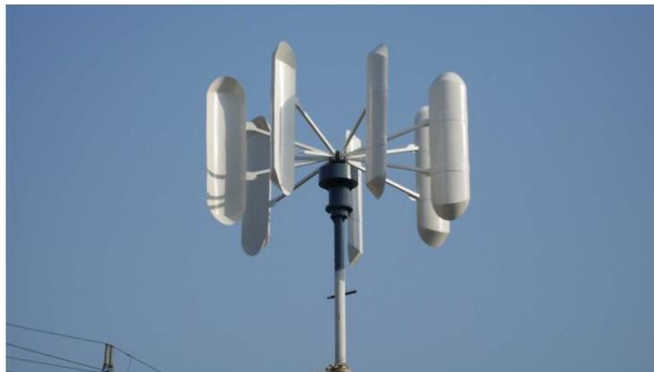
Figura 17. Aerogenerador Savonius. (Fuente: [41]).
