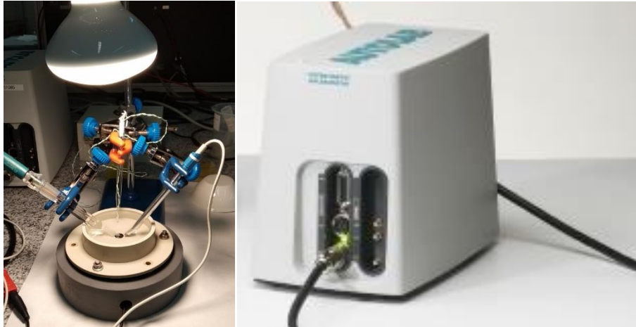
Figura 19. Montaje de electrodos, termo par y electrolito, a la izquierda, y potenciostato PGSTAT204 de Metrohm AUTOLAB, a la izquierda.
