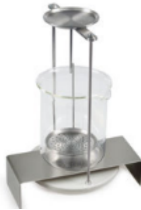
Figura 15. Equipo montado en la balanza Kern 770 para obtener las masas necesarias para el principio de Arquímedes (Kern, 2019).
