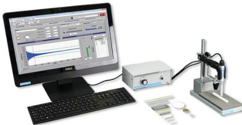
Figura 16. Equipo Sonelastic para muestras pequeñas que contiene: percutor, sensor acústico, ordenador para soportar el software específico y soporte para muestras (Sonelastic, 2019).
