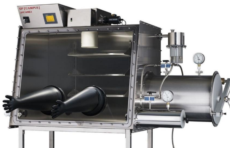
Figura 12. Cámara de guantes con atmosfera controlada y controlador de presión.
