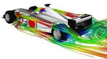
Ilustración 1: Aplicación de un CFD a la Aerodinámica de un coche de fórmula 1 (Gráfica tomada de la página web de FLUENT, Un CFD de uso comercial).
