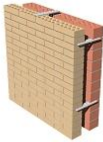
Ilustración 11: Perspectiva de un cerramiento convencional de doble hoja con acabado en ladrillo caravista
