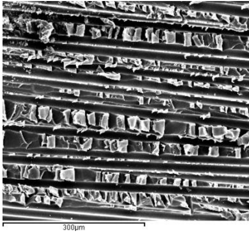
Figura 5.6. Laminado 1 (curado recomendado). Zona rica en fibras.
