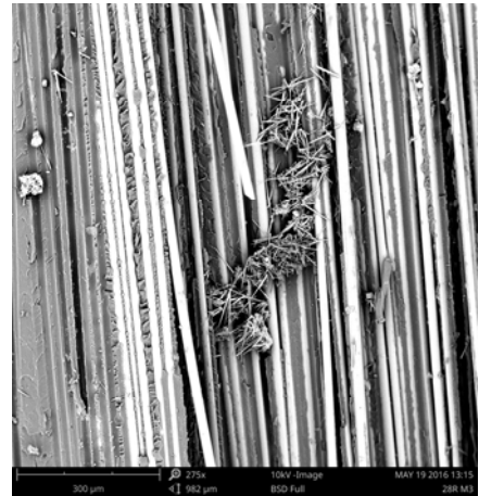
Figura 5.18. Zona de aparición etringita tras 7 días en hormigón.
