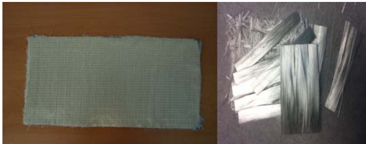
Figura 4.1. Tejido de fibra de vidrio multidireccional. Ampliación: fibras a 0^\circ (primer plano), 90^\circ (horizontal) y fibras cortas tipo mat (fondo).
