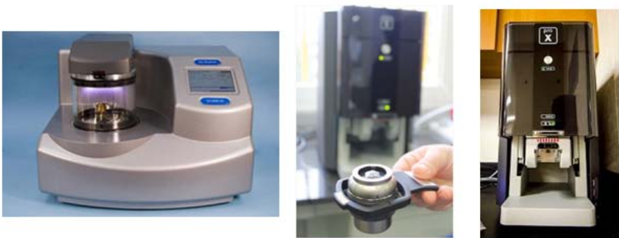
Figura. 4.15. Imagen del equipo de deposición de oro, porta muestra y colocación en el SEM.
