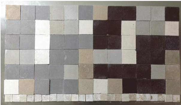
Figura 9. Disposición en taller de Mosaico Nolla del módulo empleado en los antepechos de las fachadas (2014).
