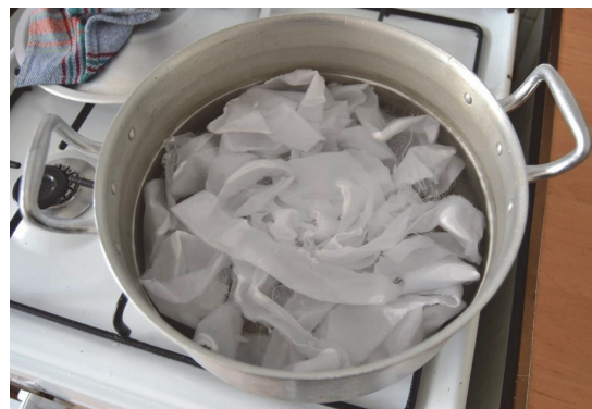
Figura 2. Prelavado del tejido en agua destilada.
