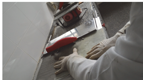
Figura 3. Circular de mesa con disco de diamante.
