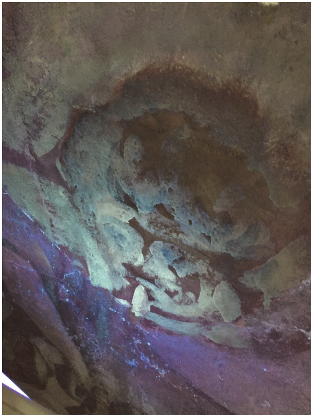
Figura 2. La luz ultravioleta permite observar la cantidad y extensión de los repintes sobre la pintura al fresco de la Iglesia de los Santos Juanes de Valencia.
