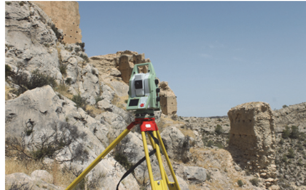
Figura 6. Multiestación tomando datos de la muralla
