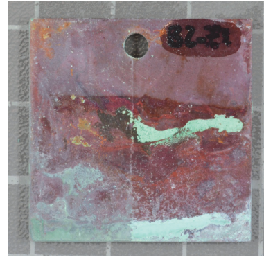
Figura 14. Muestra tras el envejecimiento por HR.
