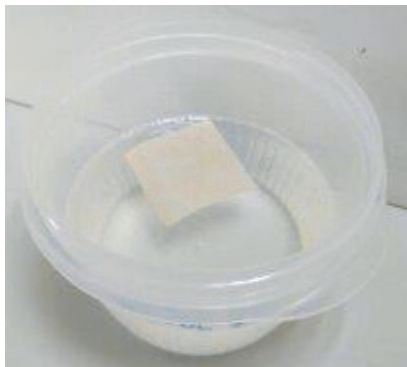
Figura 6. Aclarado, después del lavado en medio acuoso con tensoactivo, en agua desionizada.
