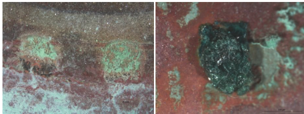
Figuras 9 y 10. Detalles de la formación de cráteres y cristales de hidroxiclurosos.
