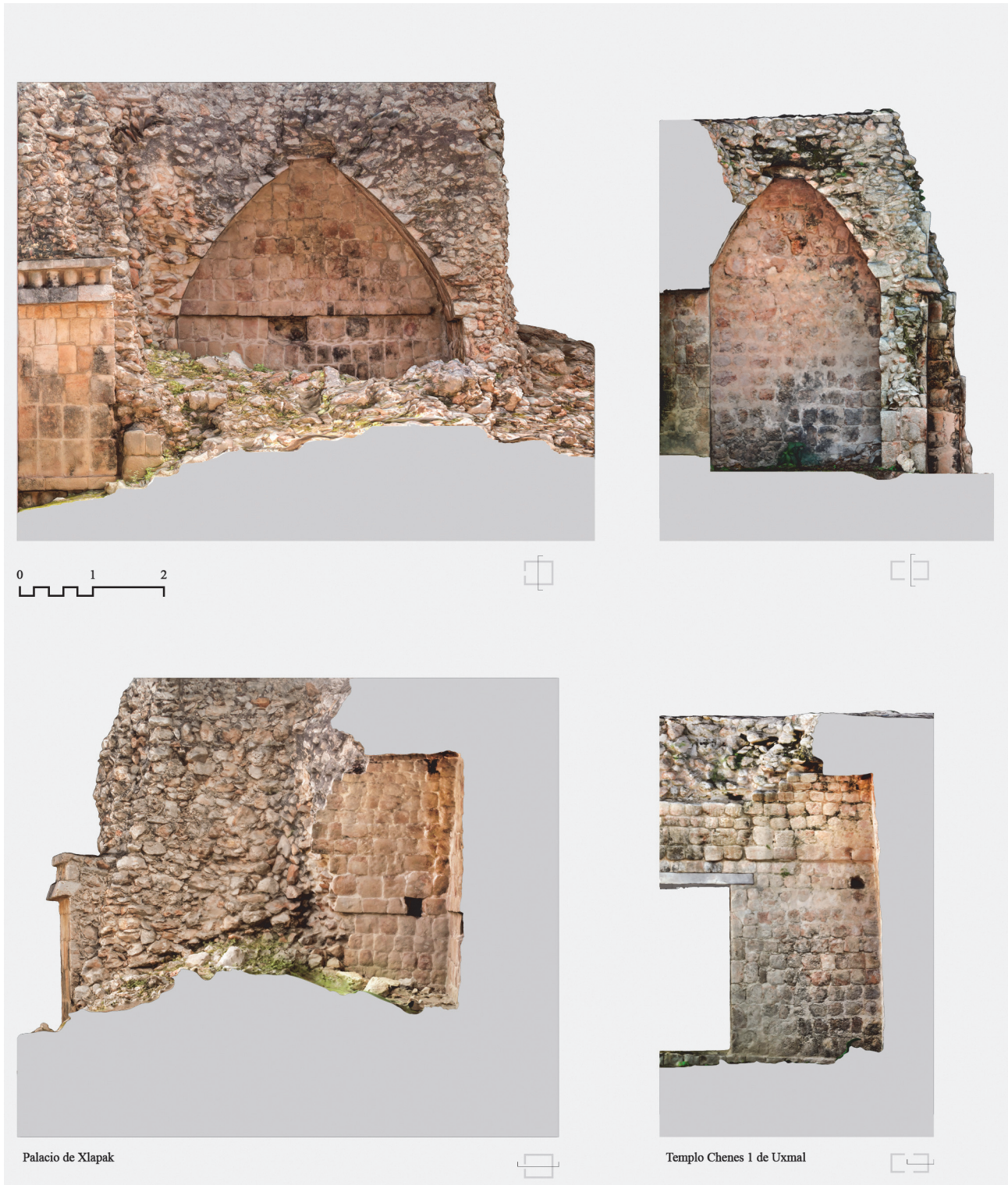
Figura 3. Secciones transversales y longitudinales de las bóvedas.
