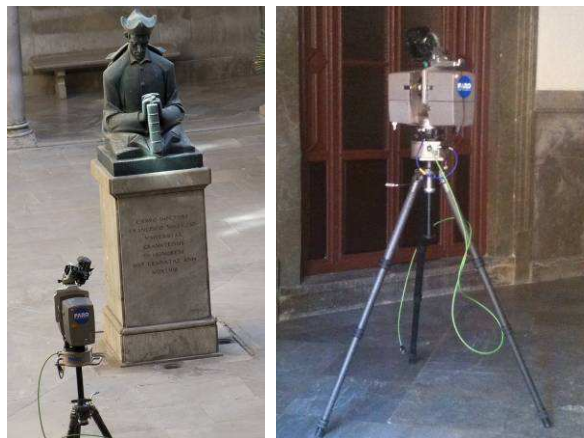
Figura 2: Digitalización de Patrimonio Inmueble con escáner Faro LS.
