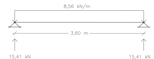
Figura 55. Vigueta más desfavorable bajo zonas húmedas.
