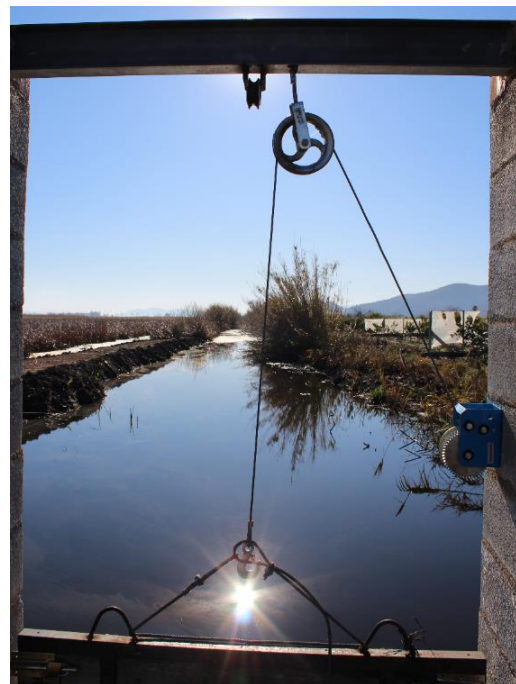
Figura 23. Testellador modern tirat per un motor a la Séquia Travessera. Font: Elaboració pròpia
