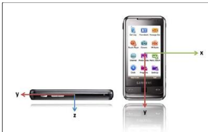
Figura C2. Los 3 ejes de coordenadas de los valores obtenidos por los acelerómetros.
